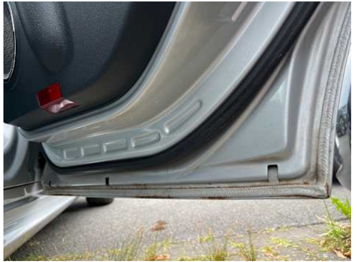
Türe hinten rechts (Rost)
