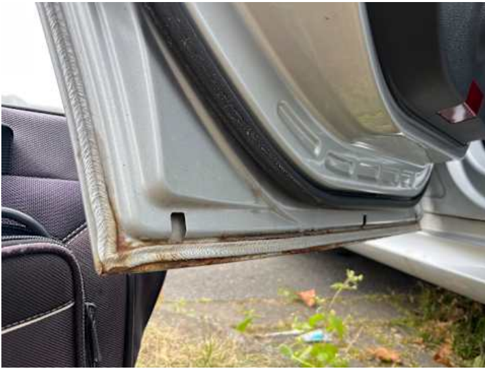
Türe hinten links (Rost)
