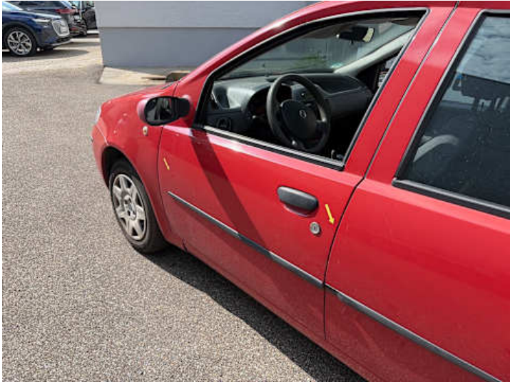
Fahrtür (Ausgeblichen/Matt, Kratzer, Delle)
