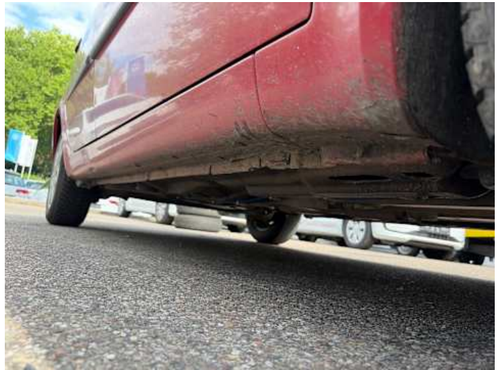
Schweller rechts (Rost)
