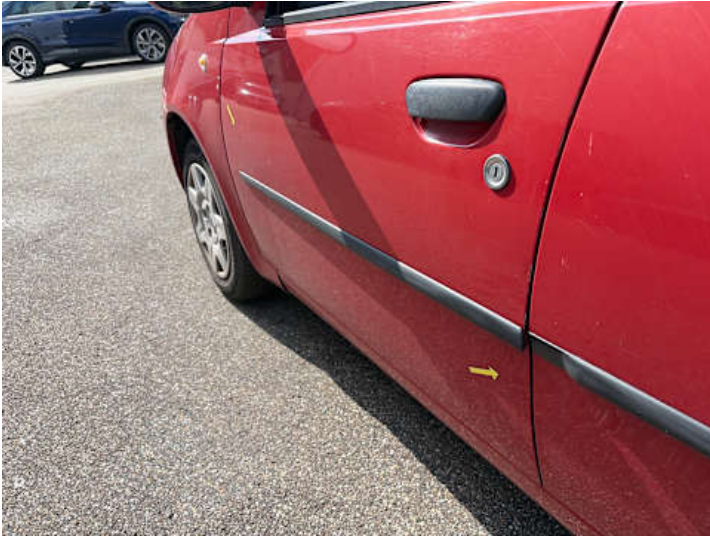
Fahrtür (Ausgeblichen/Matt, Kratzer, Delle)
