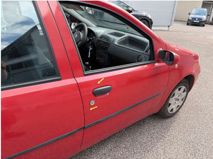
Beifahrtür (Ausgeblichen/Matt, Kratzer)
