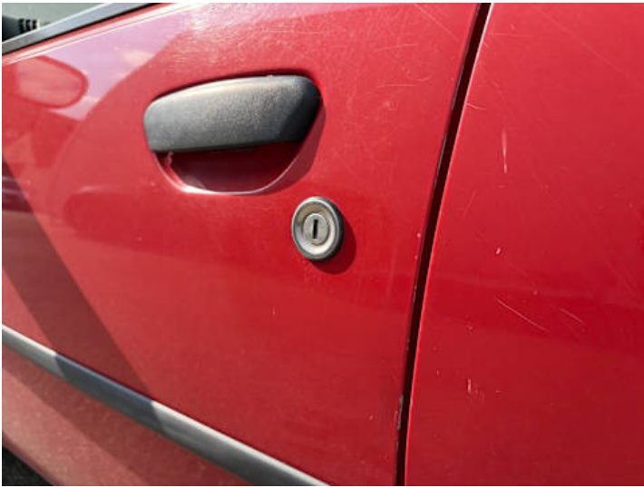
Fahrtür (Ausgeblichen/Matt, Kratzer, Delle)
