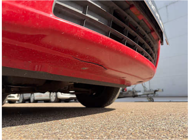
Stoßstange vorne (Riss/Bruch)
