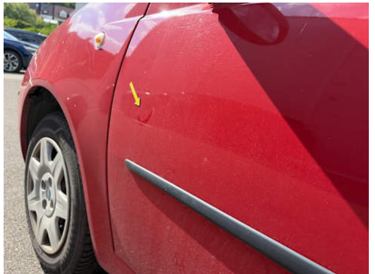
Fahrtür (Ausgeblichen/Matt, Kratzer, Delle)
