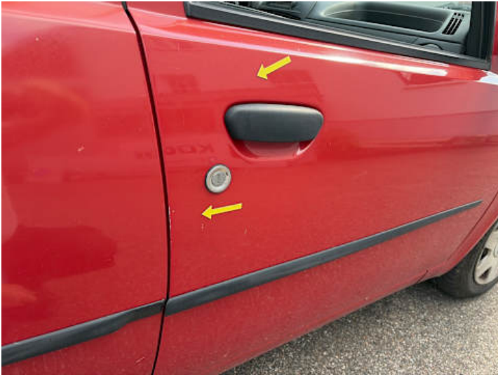
Beifahrtür (Ausgeblichen/Matt, Kratzer)
