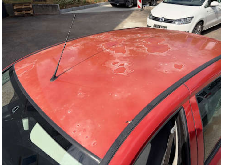
Dach (Ausgeblichen/Matt, Kratzer, Lackschaden)
