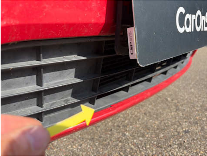
Stoßstange vorne (Riss/Bruch)
