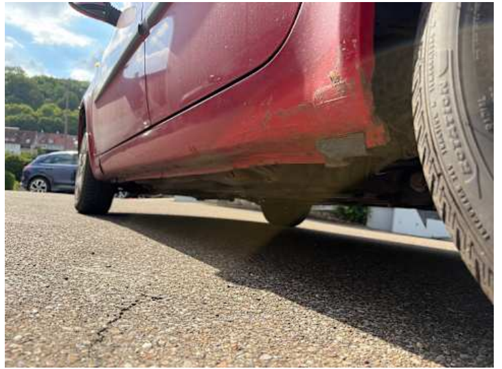
Schweller links (Delle, Rost, Kratzer)
