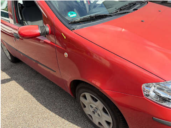
Kotflügel vorne rechts (Kratzer, Delle)
