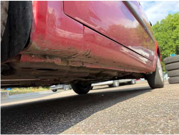
Schweller links (Delle, Rost, Kratzer)
