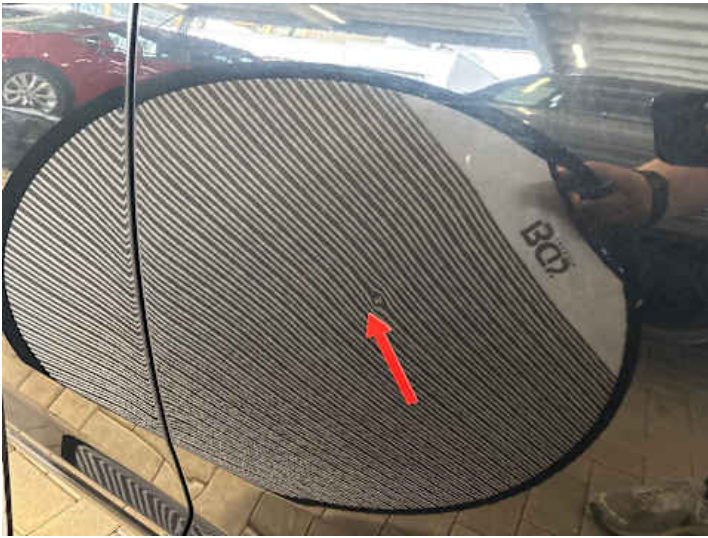
Türe hinten links (Delle)
