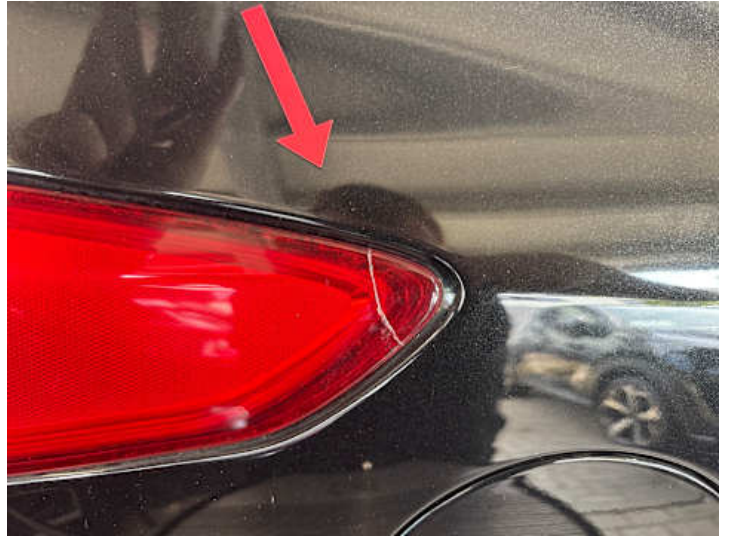
Rücklicht (rechts) (Riss/Bruch)
