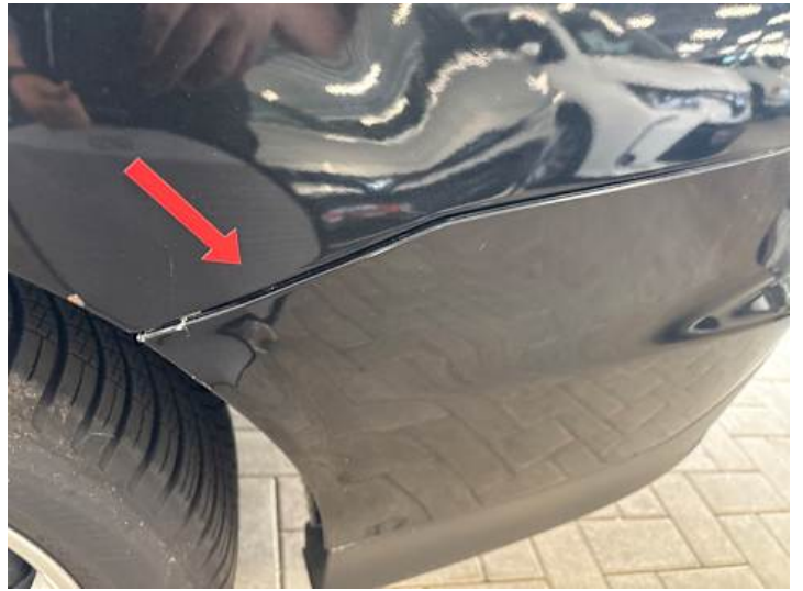
Stoßstange hinten (Spaltmaße ungenau)
