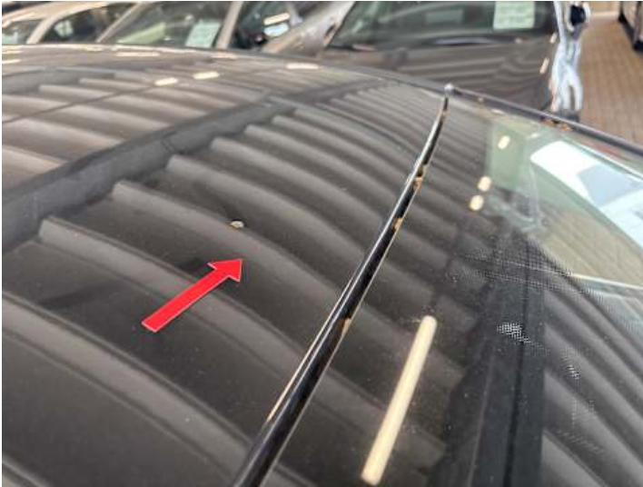
Dach (Rost, Steinschlag)
