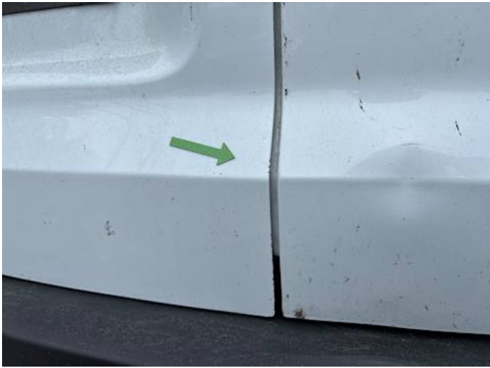
Heckklappe (Kratzer, Rost)
