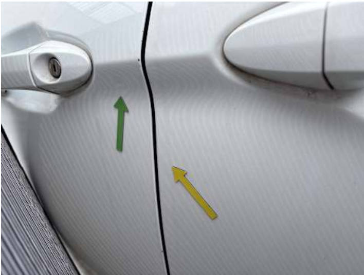
Fahrtür (Delle, Kratzer)
