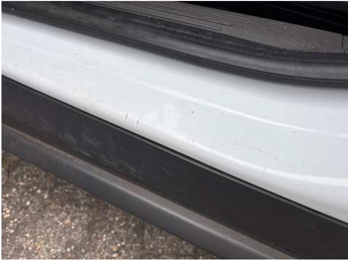
Schweller links (Delle, Kratzer)
