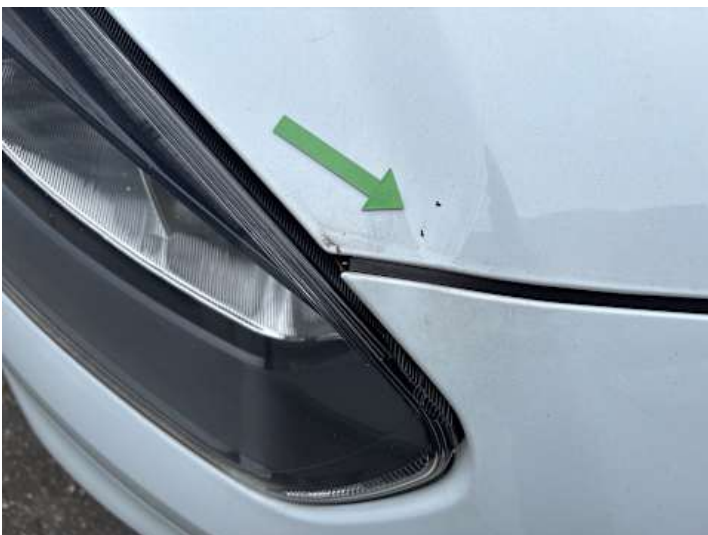
Motorhaube (Kratzer, Rost)
