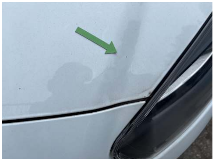
Motorhaube (Kratzer, Rost)
