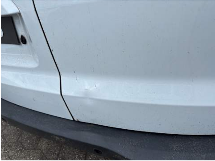
Heckklappe (Verformung, Kratzer)
