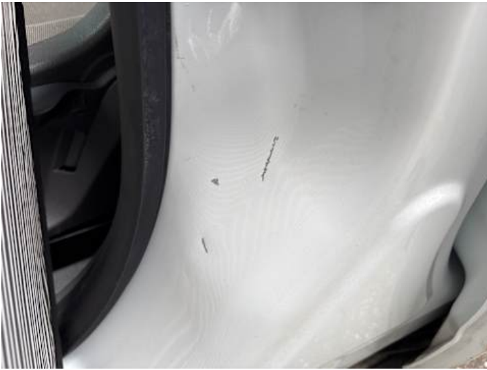
Schweller links (Delle, Kratzer)
