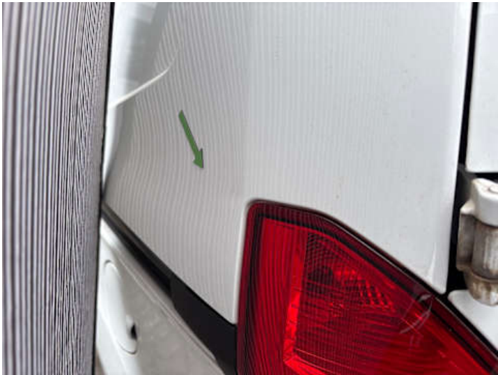
Seitenteil hinten links (Verformung)
