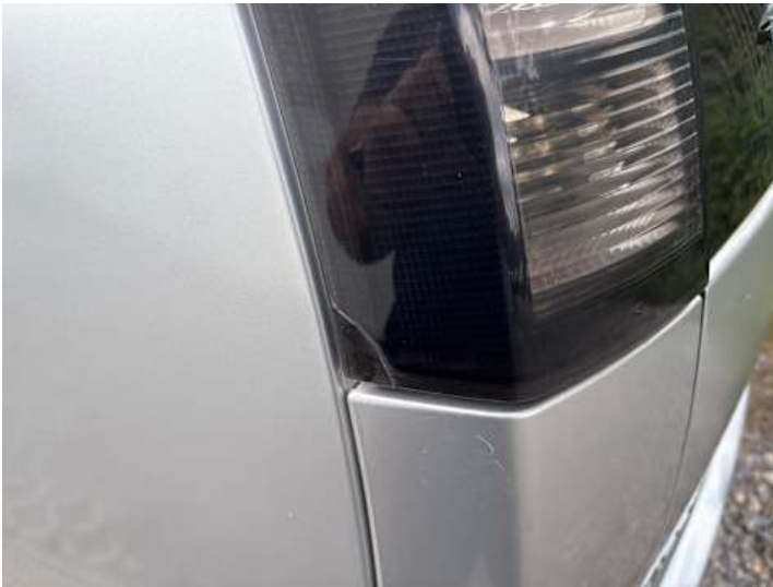
Rücklicht (links) (Riss/Bruch)
