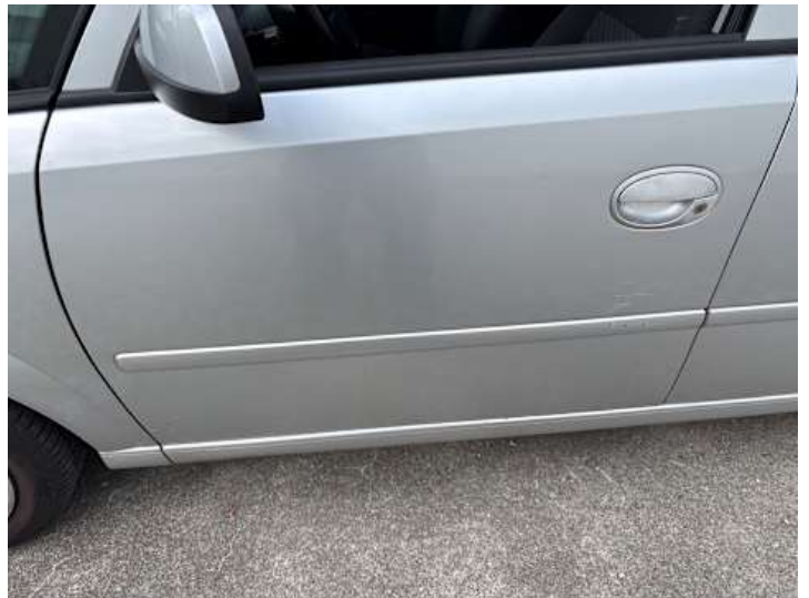
Fahrtür (Delle, Kratzer)
