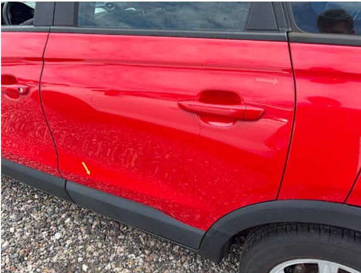
Türe hinten links (Kratzer)
