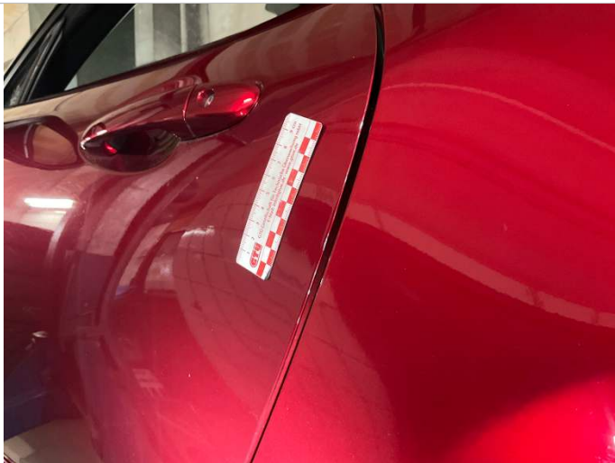
Türe vorne links Türkante Lackbeschädigung
