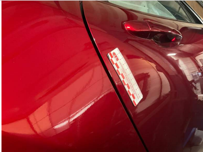
Türe vorne rechts Türkante Lackbeschädigung
