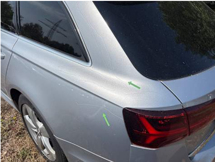
Seitenteil hinten links (Kratzer)
