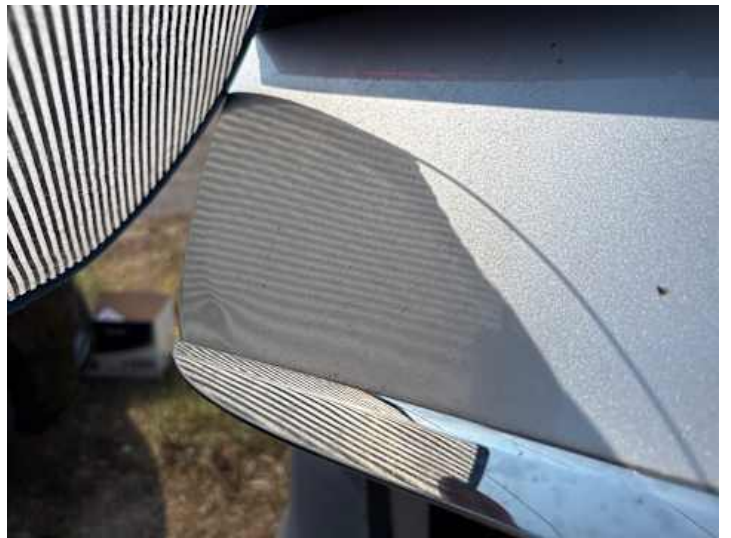
Heckklappe (Delle, Verformung)
