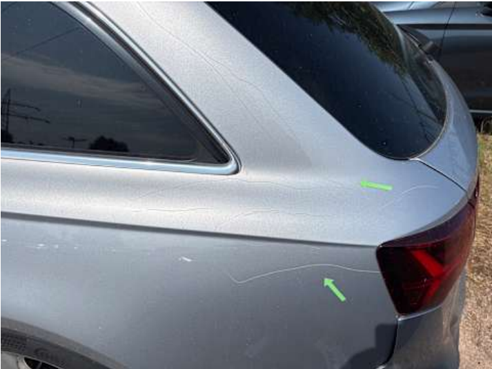
Seitenteil hinten links (Kratzer)
