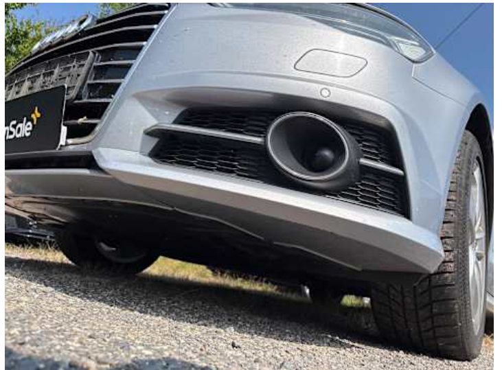
Stoßstange vorne (Kratzer, Steinschlag)
