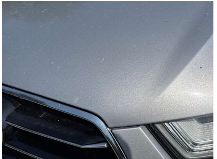
Motorhaube (Steinschlag, Lackschaden)
