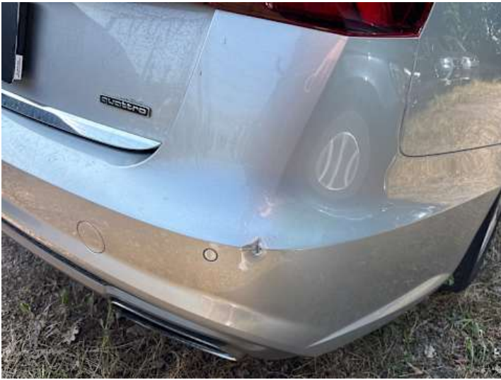
Stoßstange hinten (Riss/Bruch, Kratzer, Delle, Verformung, Spaltmaße ungenau)
