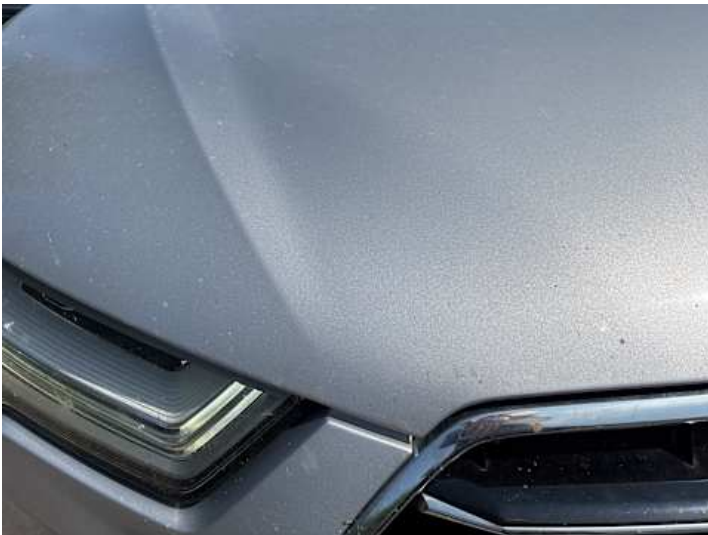
Motorhaube (Steinschlag, Lackschaden)
