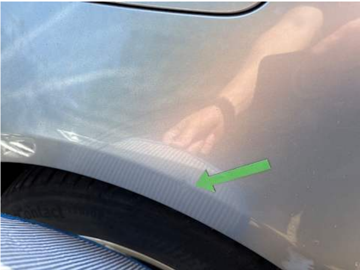
Seitenteil hinten rechts (Kratzer, Delle)
