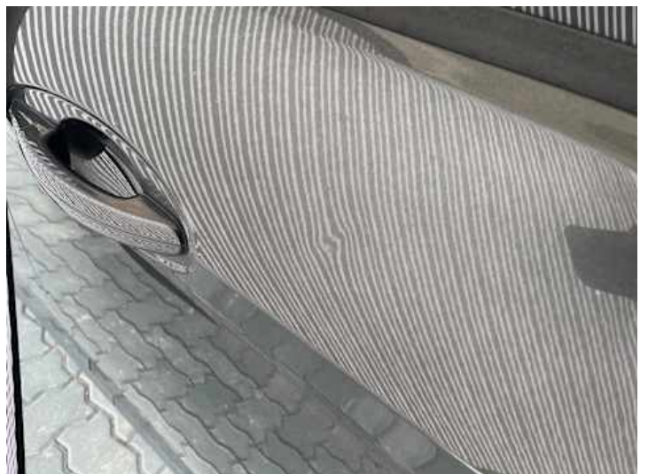
Türe hinten links (Delle)
