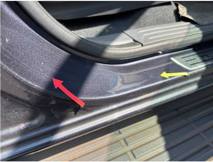
Schweller rechts (Kratzer, Delle)
