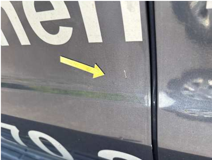
Fahrtür (Rost, Lackschaden)
