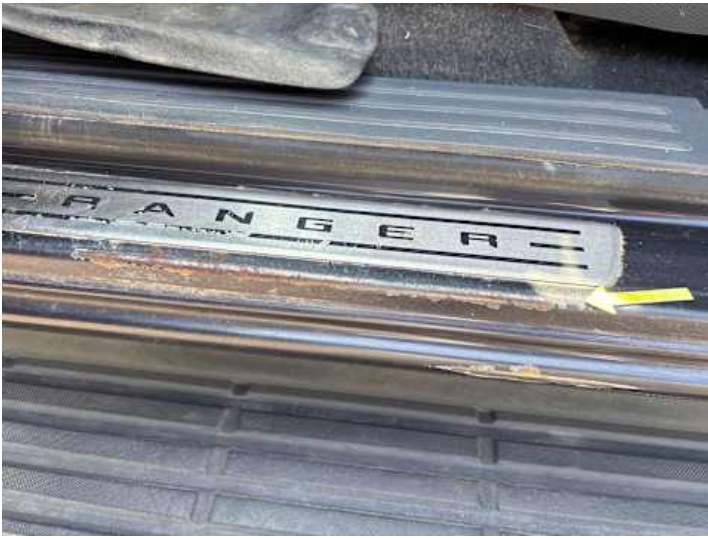
Schweller links (Rost, Lackschaden)
