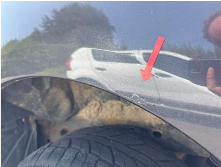
Seitenteil hinten links (Rost)
