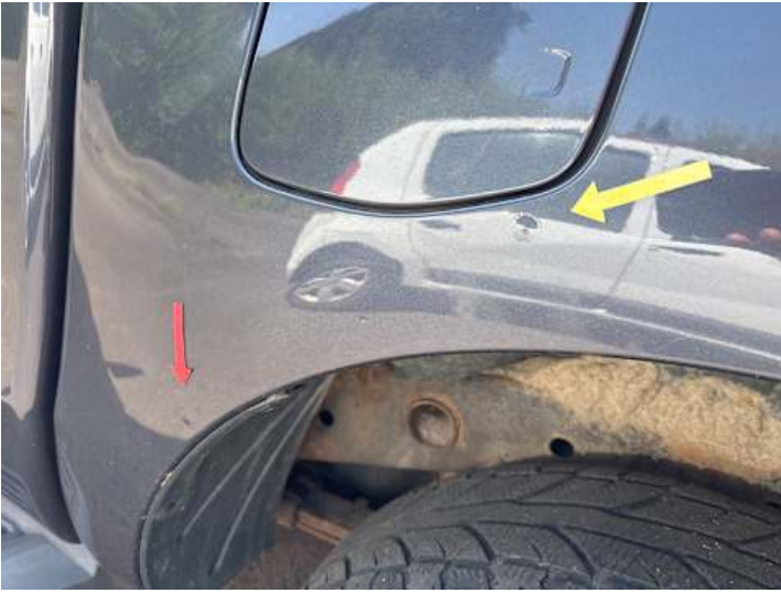
Seitenteil hinten links (Rost)
