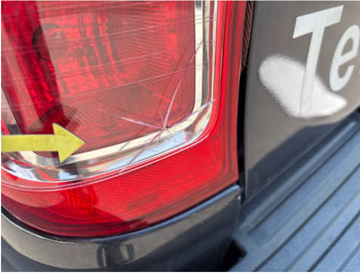
Rücklicht (links) (Riss/Bruch)
