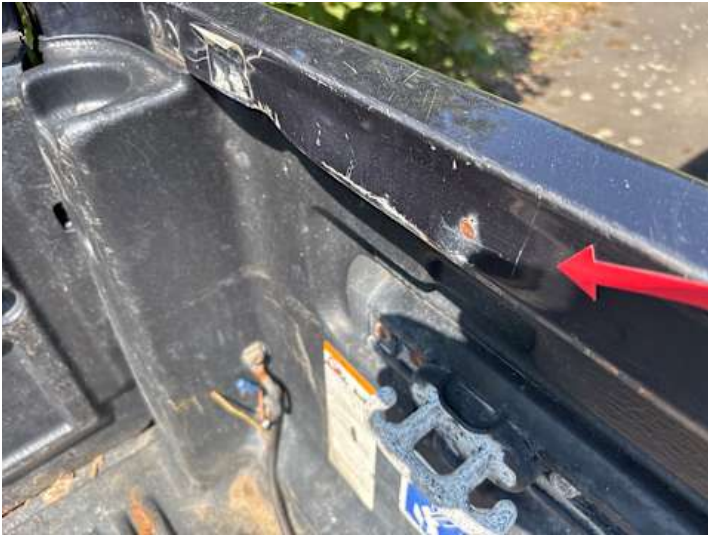
Seitenteil hinten links (Rost, Lackschaden, Verformung)
