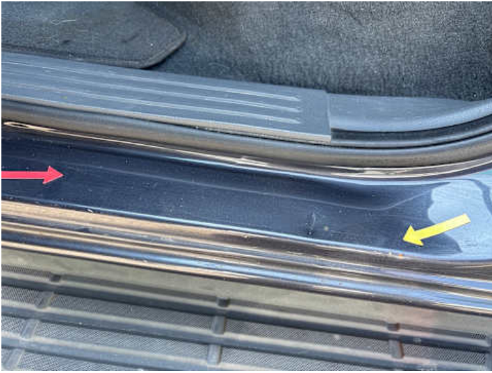
Schweller links (Delle, Lackschaden, Rost)
