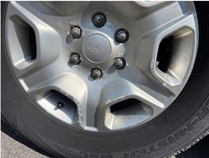
Rad (Kratzer, Anderer Schaden): Lackschaden
