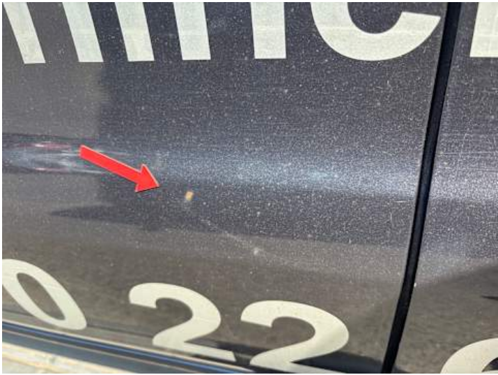
Türe hinten rechts (Rost)
