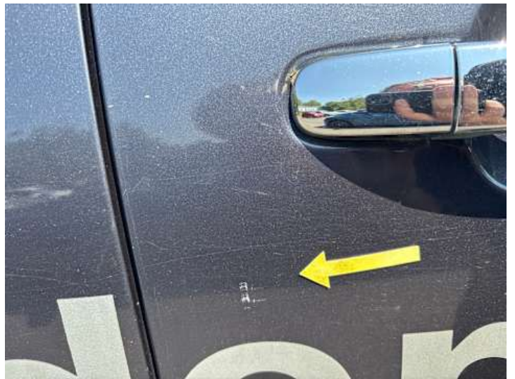
Beifahrtür (Kratzer, Lackschaden)
