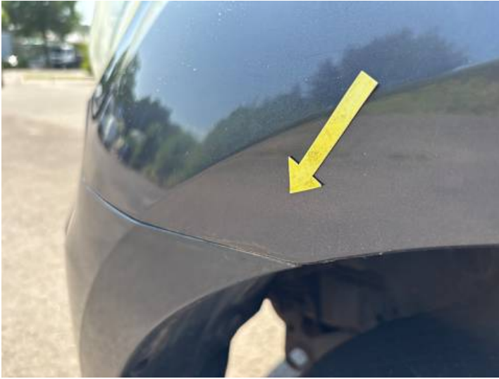
Kotflügel vorne links (Rost)
