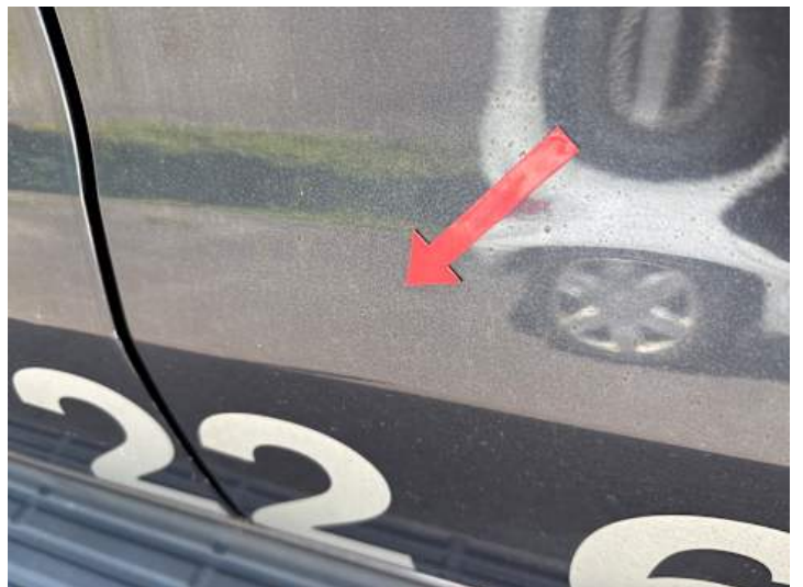
Türe hinten links (Rost)
