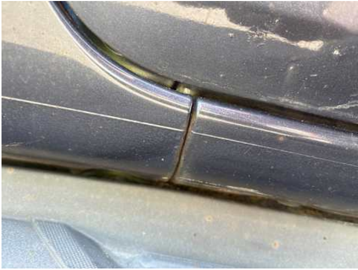
Schweller links (Rost)
