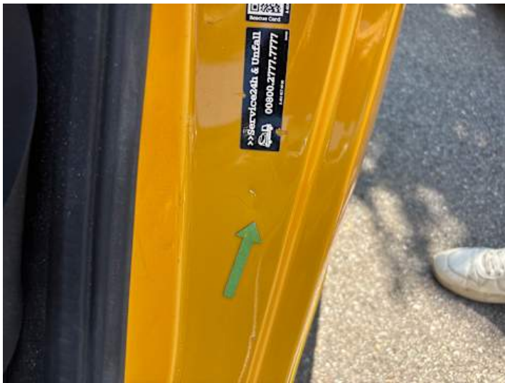
Fahrtür (Delle, Kratzer)
