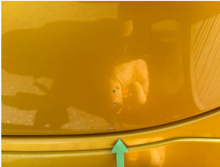
Fahrtür (Kratzer, Unsachgemäß instand gesetzt)
