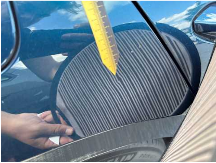
Seitenteil hinten rechts (Delle, Lackschaden)
