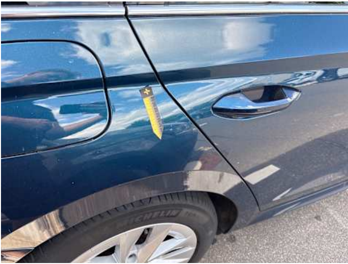
Seitenteil hinten rechts (Delle, Lackschaden)
