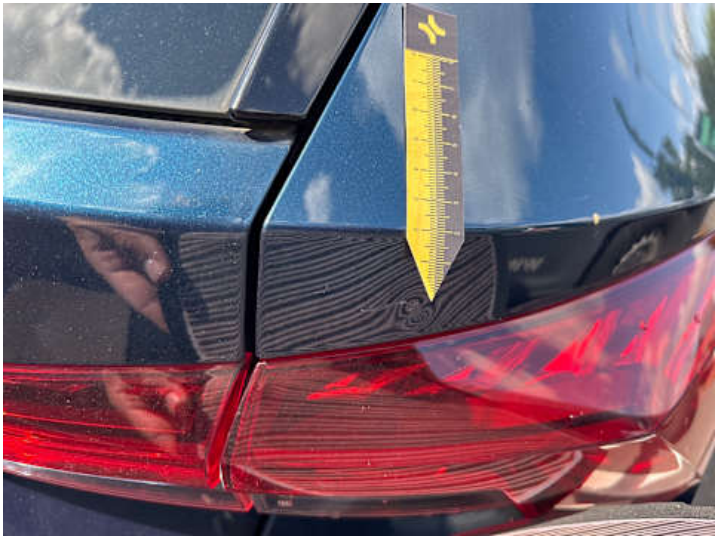
Seitenteil hinten rechts (Delle, Lackschaden)
