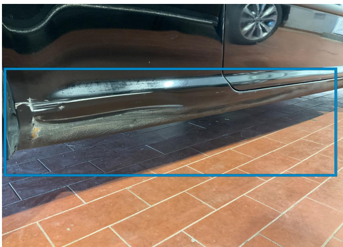
7. Einstiegsblech / MitteRechts Karosserie / Delle / Dent -
