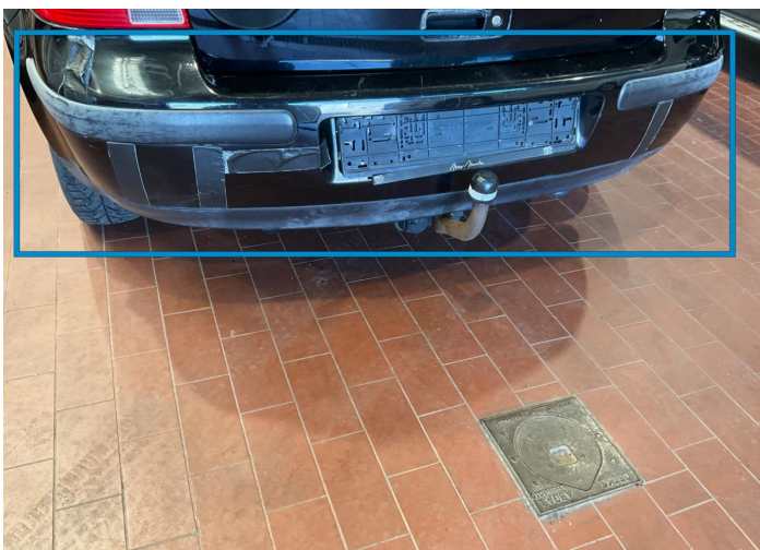
8. Stoßstange / hinten Karosserie / Bruch / Riss -
