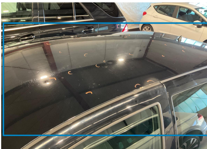
1. Dach Karosserie / Delle / Hagelschaden -
