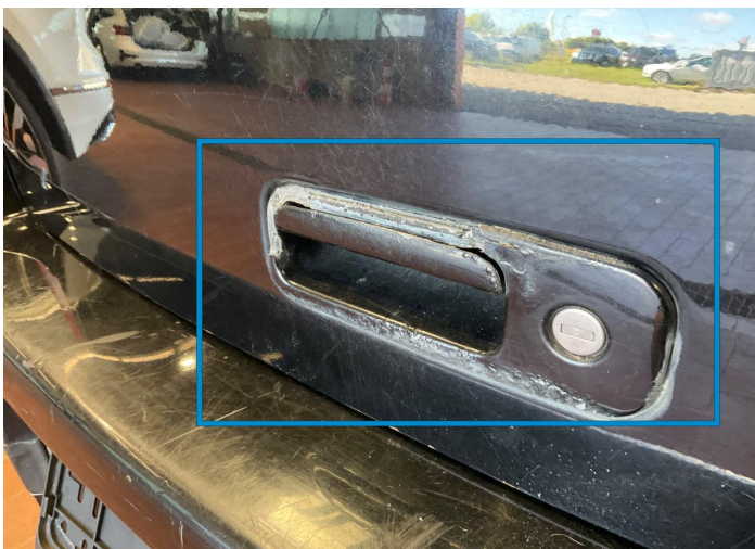
10. Kofferraum - Heckklappe - Griff / hinten Karosserie / Bruch / Riss -
