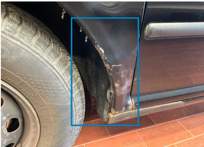
13. Kotflügel / Vorne Links Lack / Rost -
