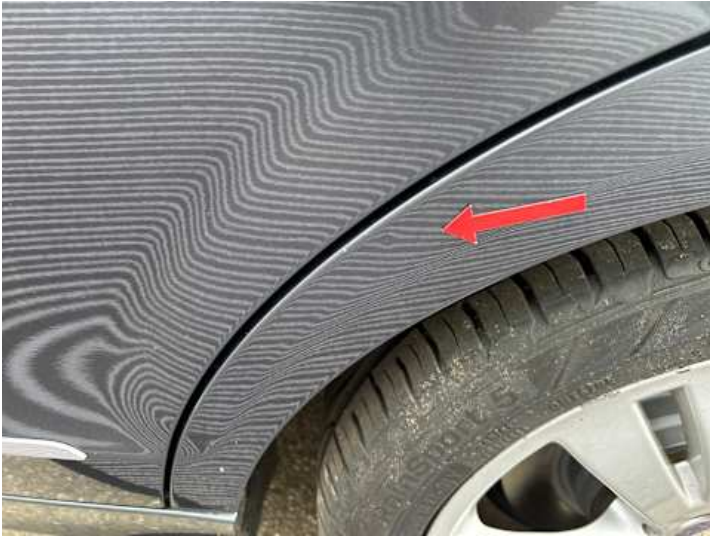
Seitenteil hinten links (Delle)
