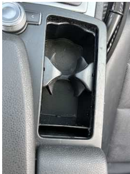
Innenraum (Anderer Schaden): Abdeckung fehlt
