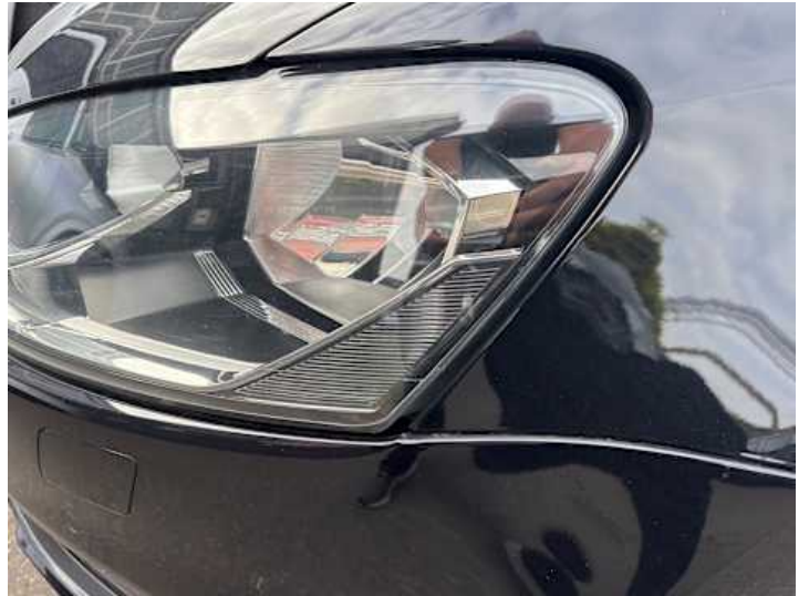
Scheinwerfer (links) (Anderer Schaden): Spaltmaß ungenau
