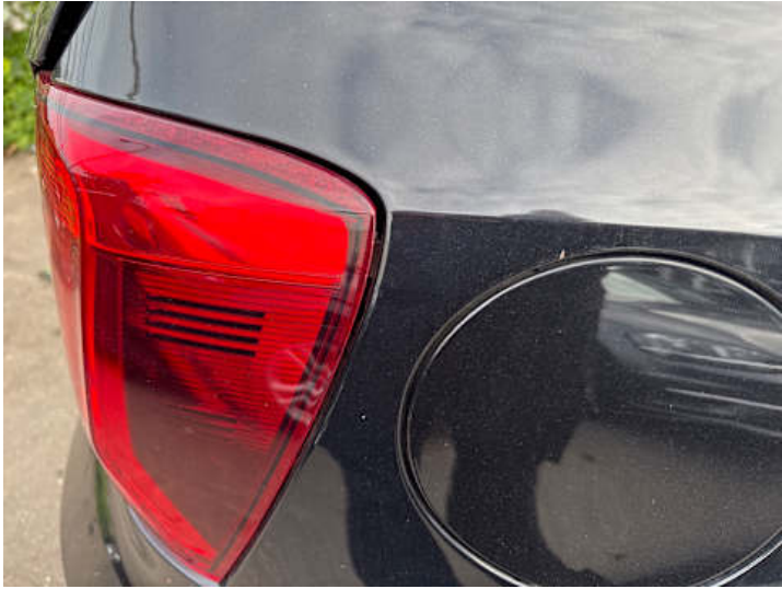
Rücklicht (rechts) (Anderer Schaden): Spaltmaß ungenau
