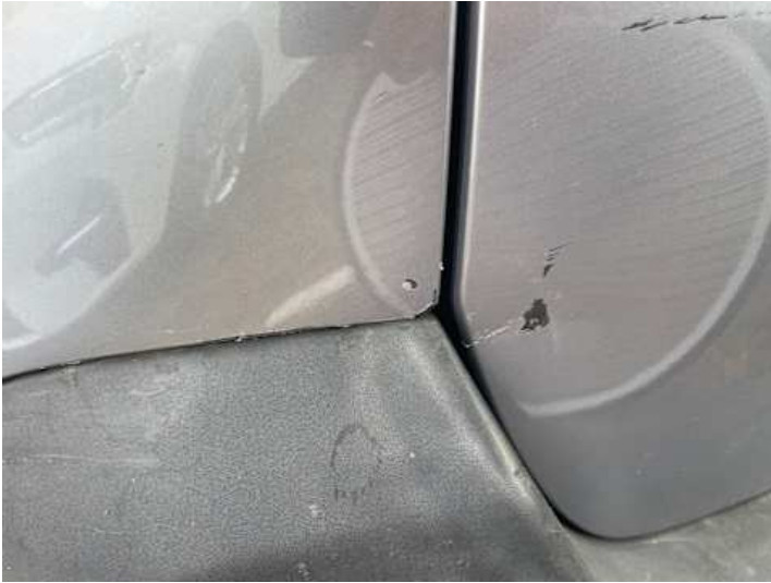
Stoßstange hinten (Riss/Bruch)
