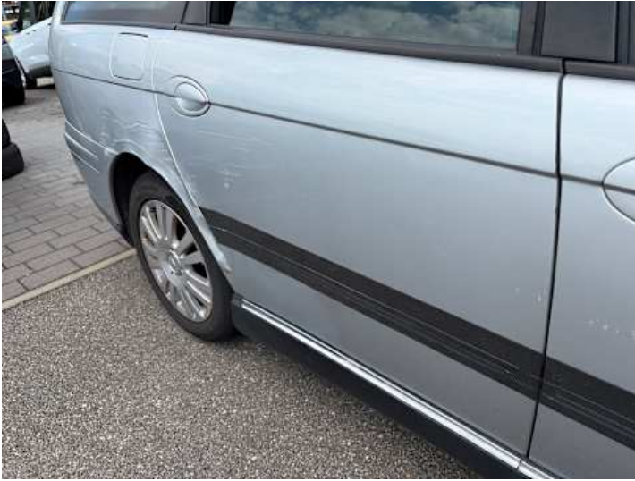
Türe hinten rechts (Kratzer, Delle, Riss/Bruch)
