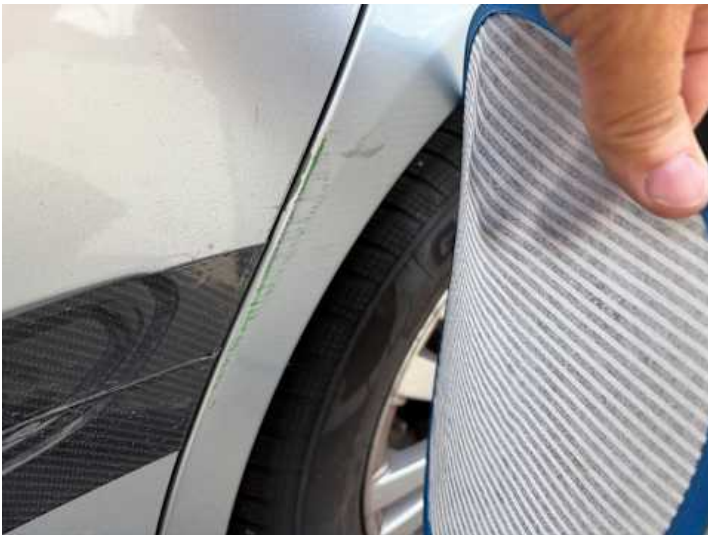
Seitenteil hinten links (Kratzer, Verformung)
