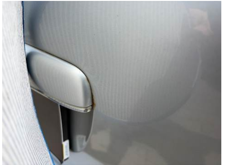
Heckklappe (Rost, Delle)
