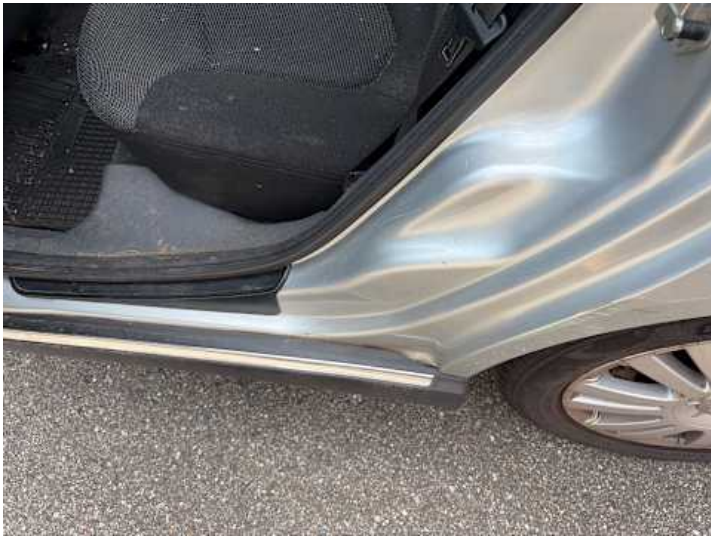
Türe hinten links (Kratzer, Delle, Riss/Bruch)
