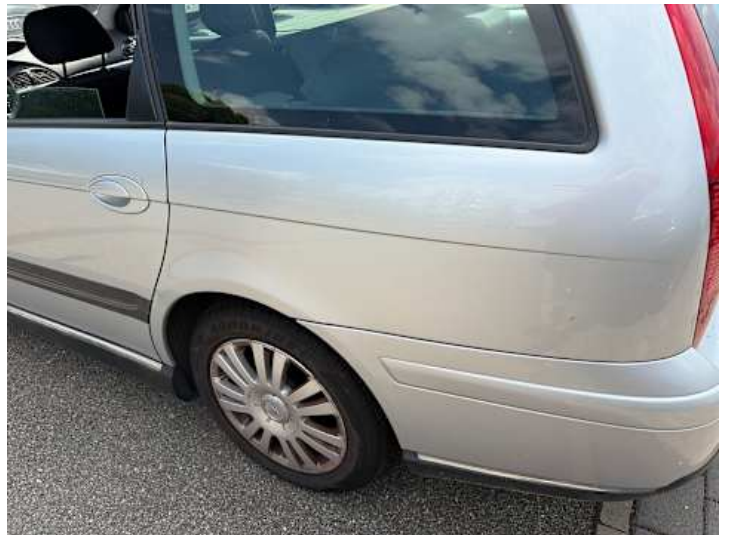
Seitenteil hinten links (Kratzer, Verformung)
