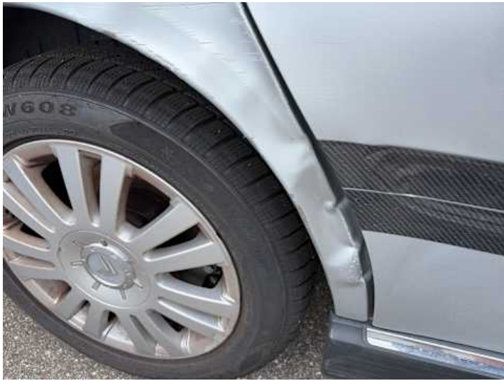
Seitenteil hinten rechts (Verformung)
