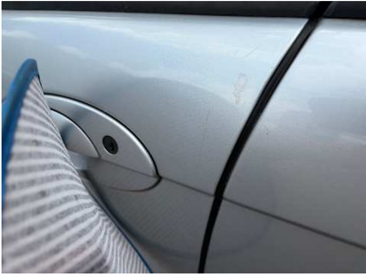
Fahrtür (Kratzer, Delle)
