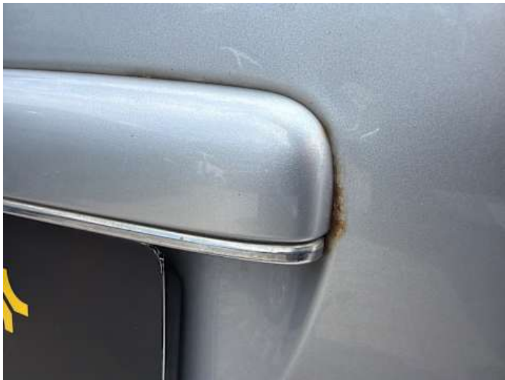
Heckklappe (Rost, Delle)
