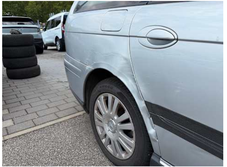
Seitenteil hinten rechts (Verformung)
