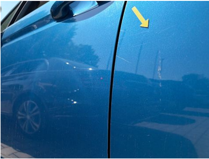
Türe hinten links (Kratzer, Rost, Delle)
