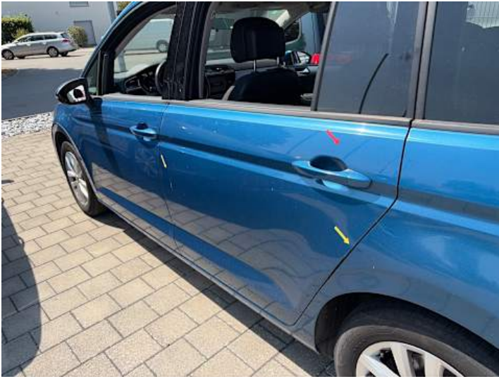
Türe hinten links (Kratzer, Rost, Delle)
