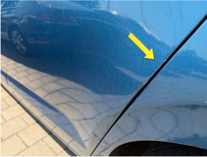
Türe hinten links (Kratzer, Rost, Delle)
