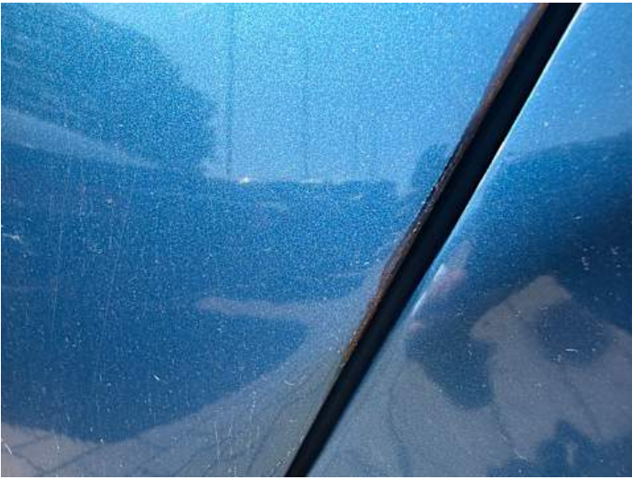
Türe hinten links (Kratzer, Rost, Delle)
