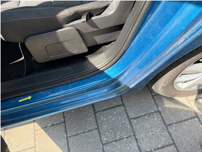
Türe hinten links (Kratzer, Rost, Delle)
