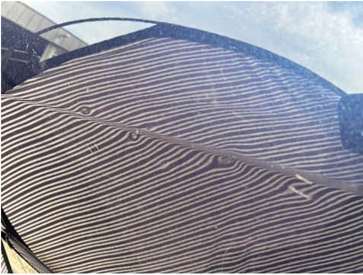
Türe hinten links (Delle, Lackschaden)
