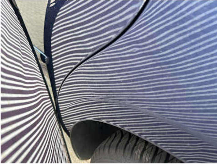
Seitenteil hinten links (Delle, Lackschaden)
