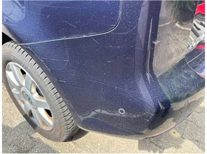
Stoßstange hinten (Lackschaden)
