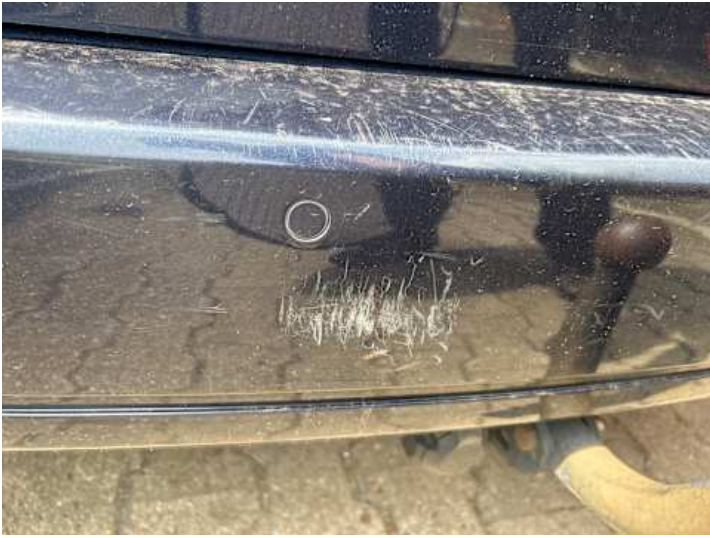
Stoßstange hinten (Lackschaden)
