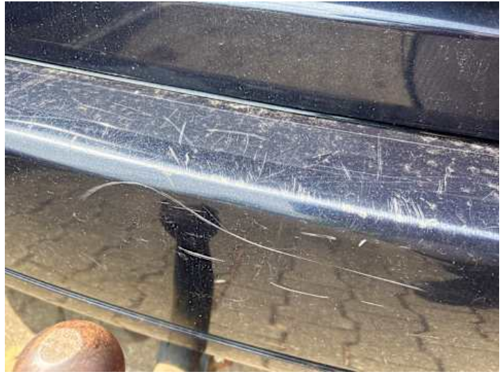
Stoßstange hinten (Lackschaden)
