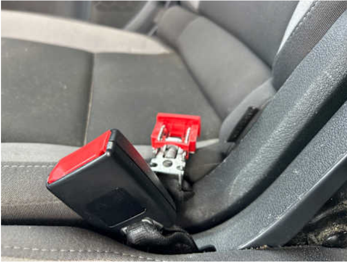
Innenraum (Diverse Schäden)
