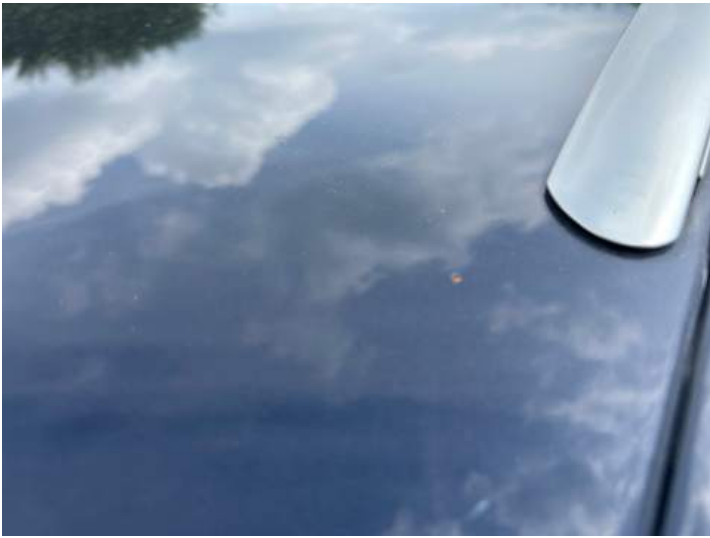
Dach (Lackschaden, Steinschlag)
