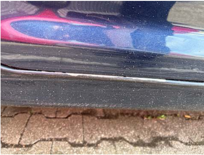
Schweller rechts (Lackschaden, Verformung)
