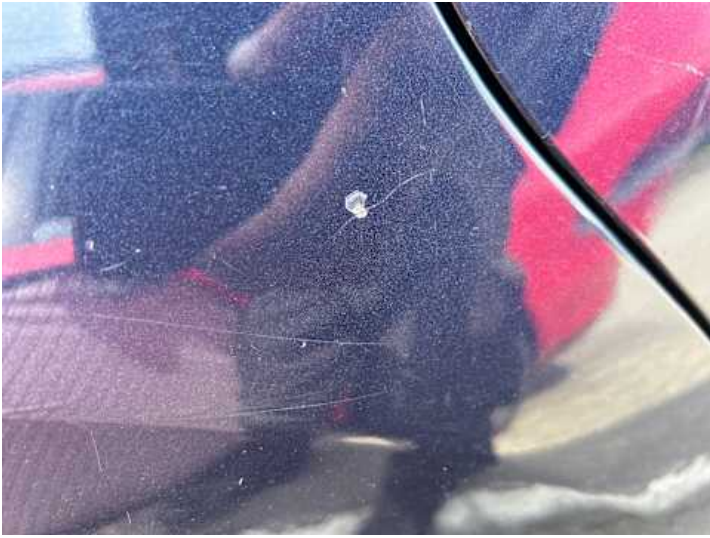
Seitenteil hinten rechts (Lackschaden)
