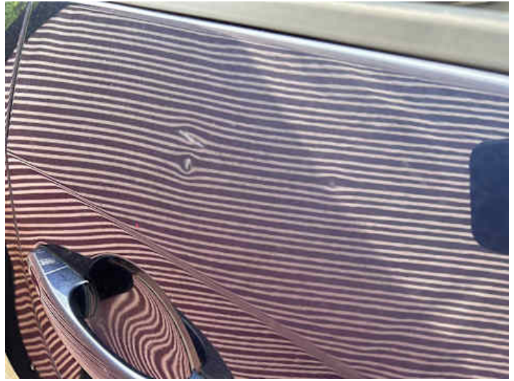
Türe hinten rechts (Lackschaden, Delle)
