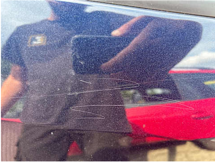
Seitenteil hinten rechts (Lackschaden)
