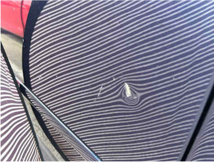
Beifahrertür (Lackschaden, Delle)
