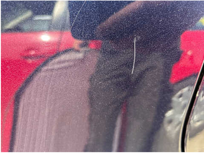
Seitenteil hinten rechts (Lackschaden)
