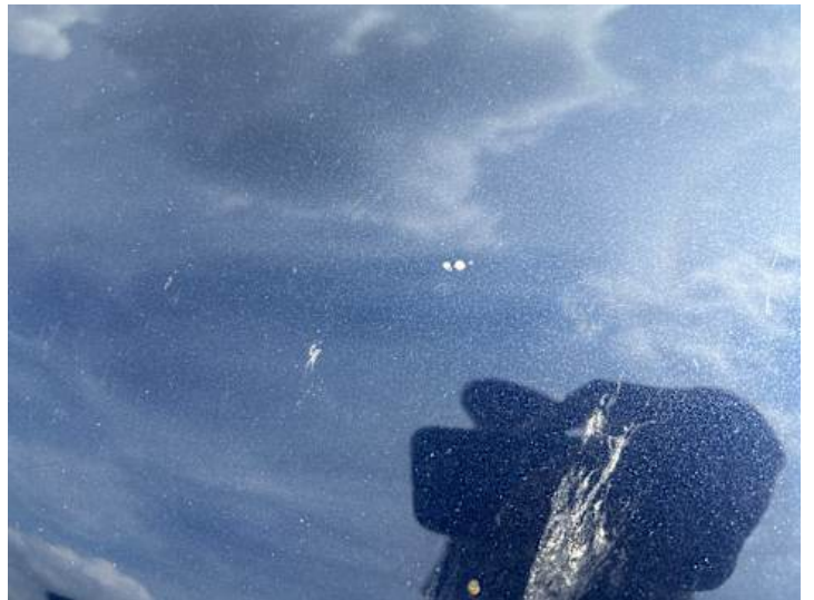
Motorhaube (Lackschaden, Steinschlag)
