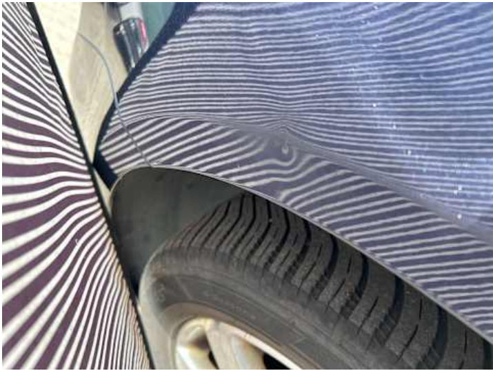
Kotflügel vorne links (Verformung)
