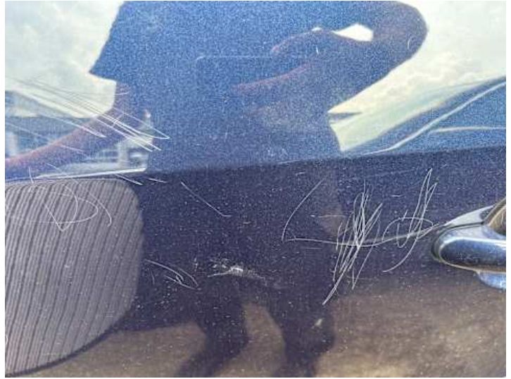
Türe hinten links (Kratzer, Lackschaden)
