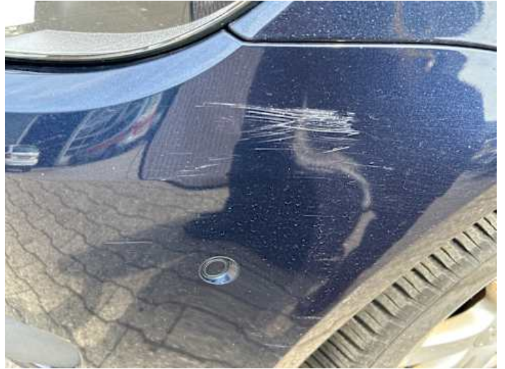
Stoßstange vorne (Lackschaden, Kratzer)
