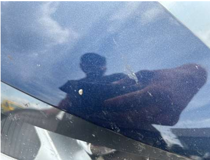
Motorhaube (Lackschaden, Steinschlag)
