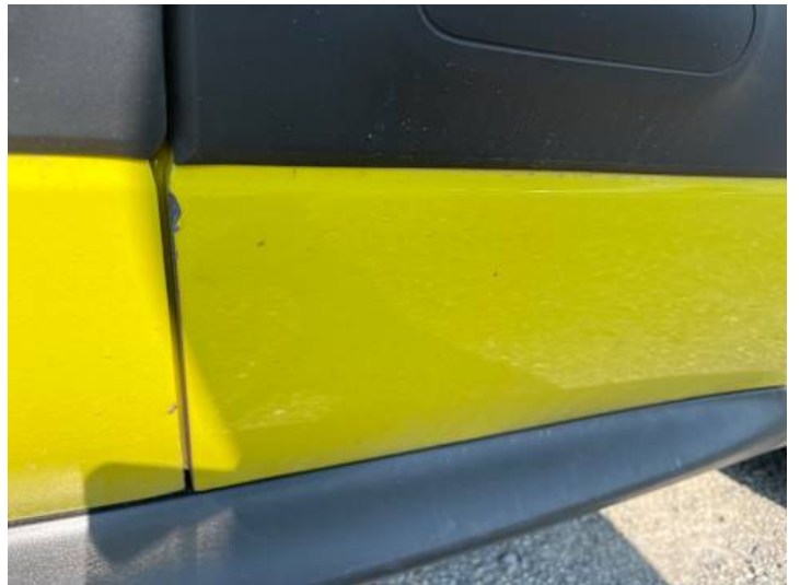
Türe hinten links (Rost)
