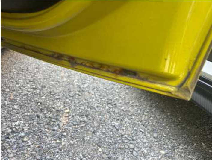
Türe hinten rechts (Rost)
