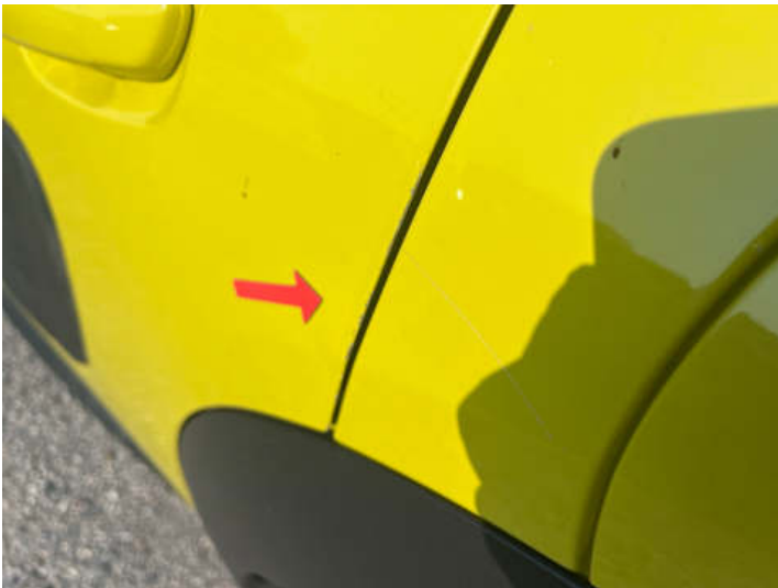
Türe hinten links (Lackschaden)
