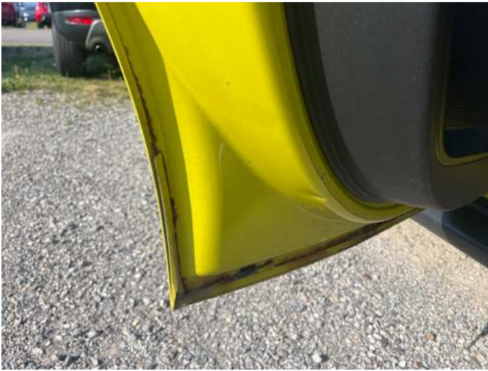
Türe hinten links (Rost)
