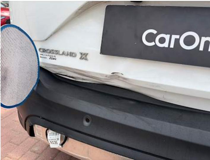
Heckklappe (Verformung, Kratzer)
