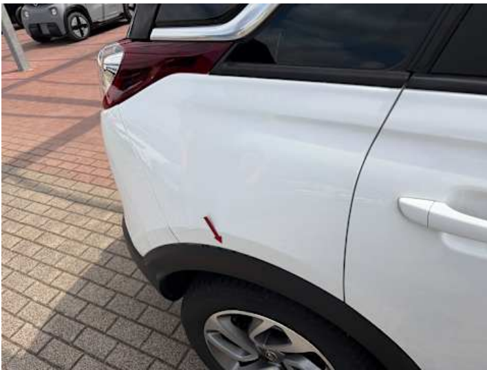
Seitenteil hinten rechts (Spaltmaße ungenau)
