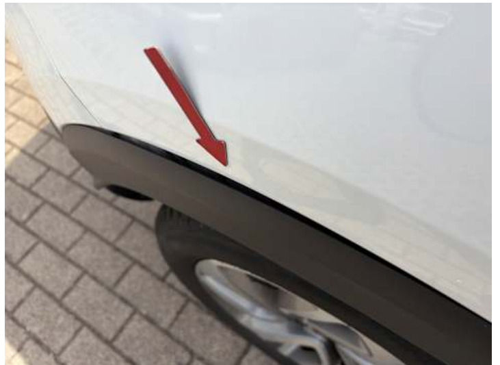
Seitenteil hinten rechts (Spaltmaße ungenau)
