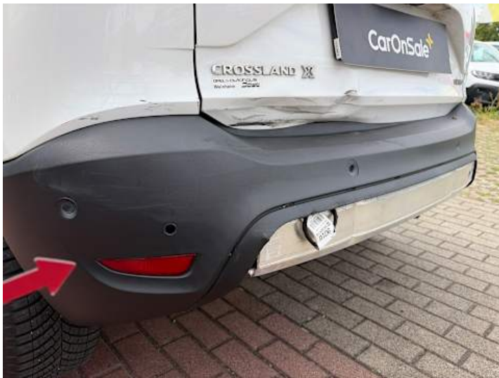
Stoßstange hinten (Riss/Bruch)
