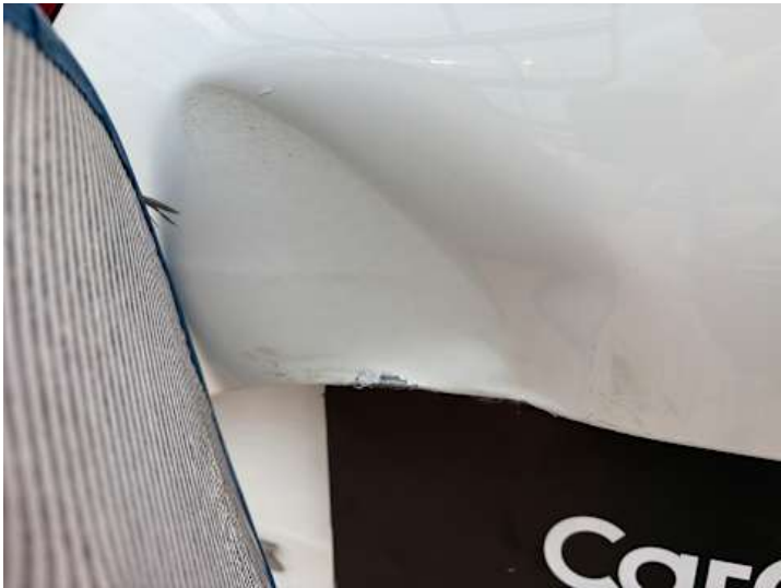
Heckklappe (Verformung, Kratzer)
