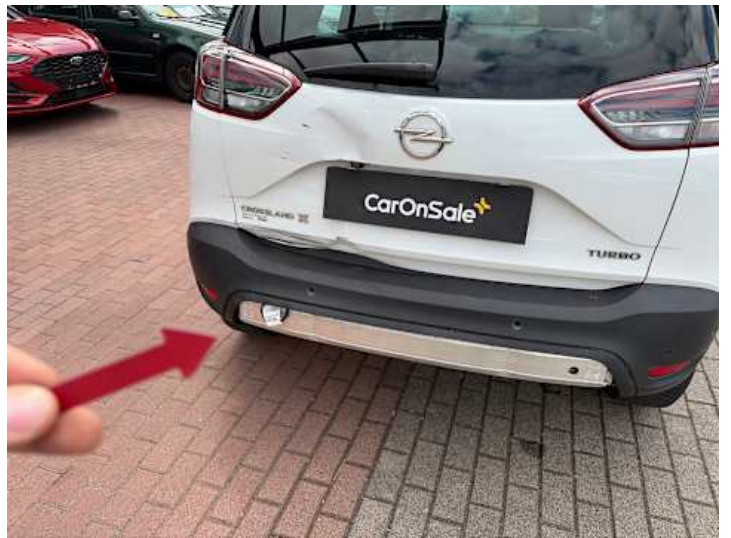
Stoßstange hinten (Riss/Bruch)
