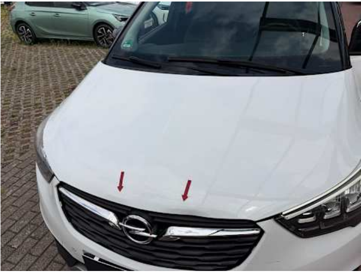
Motorhaube (Verformung, Lackschaden)
