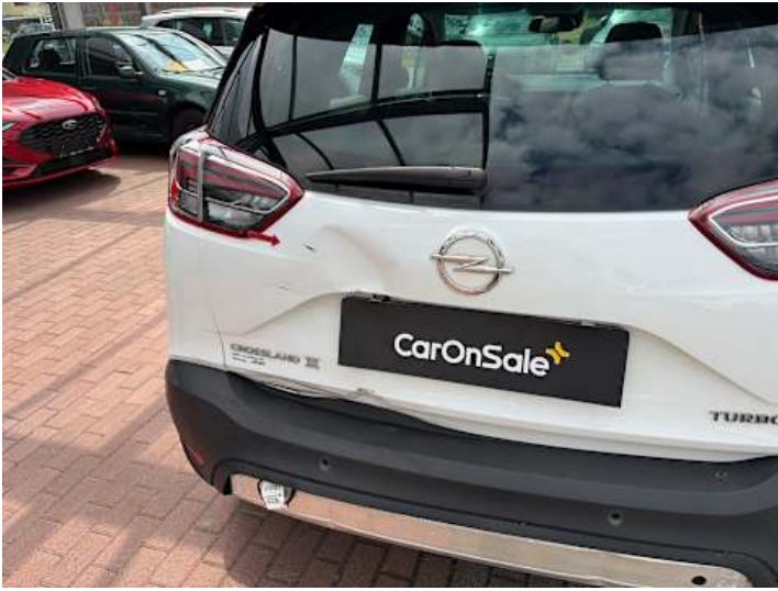
Heckklappe (Verformung, Kratzer)
