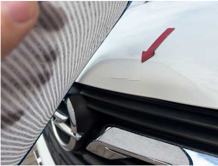
Motorhaube (Verformung, Lackschaden)
