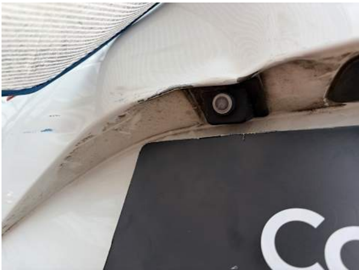
Heckklappe (Verformung, Kratzer)
