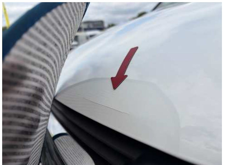
Motorhaube (Verformung, Lackschaden)
