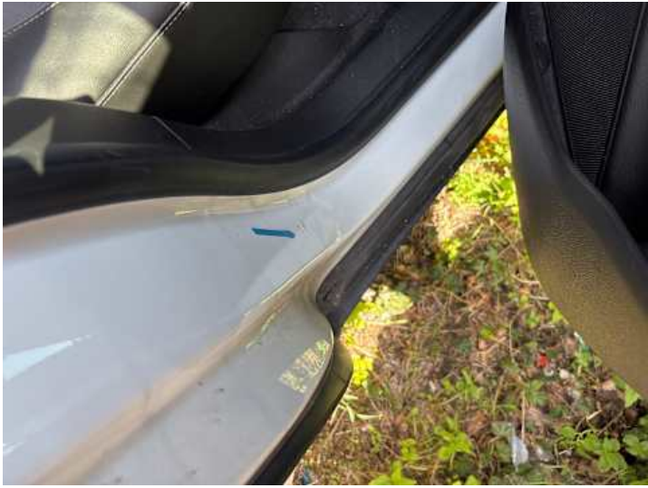
Schweller rechts (Kratzer)
