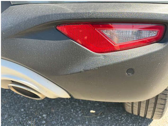
Stoßstange hinten (Kratzer, Verformung)
