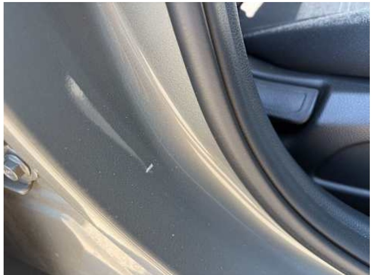
Schweller rechts (Lackschaden)
