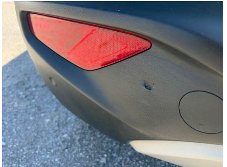
Stoßstange hinten (Kratzer, Verformung)
