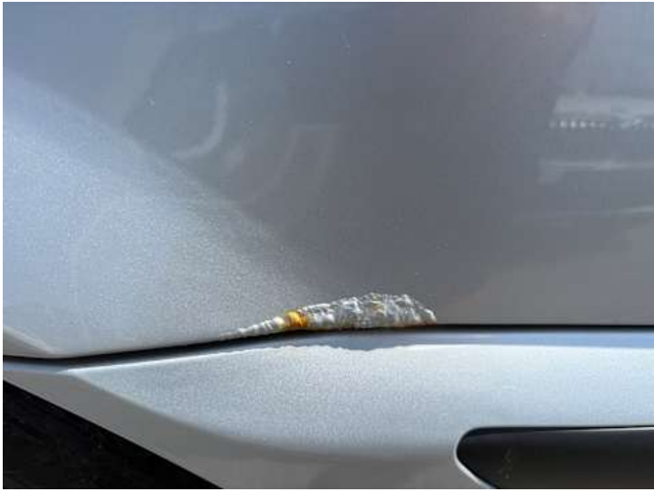
Seitenteil hinten links (Rost, Lackschaden)
