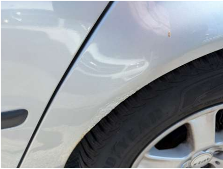
Seitenteil hinten links (Rost, Lackschaden)
