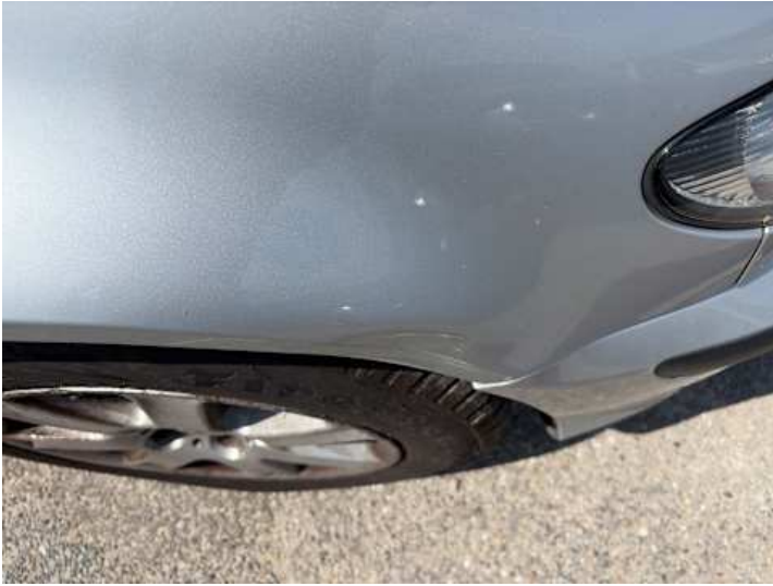
Kotflügel vorne rechts (Verformung, Lackschaden)
