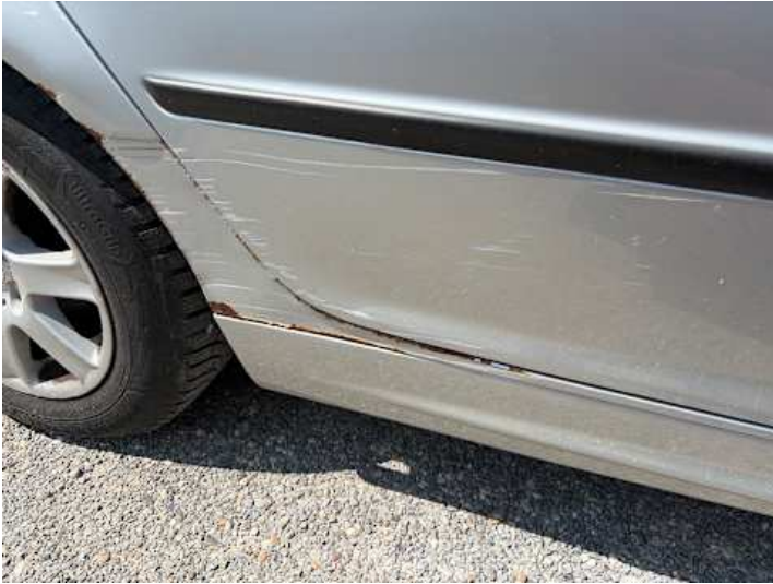
Türe hinten rechts (Kratzer, Lackschaden, Delle)
