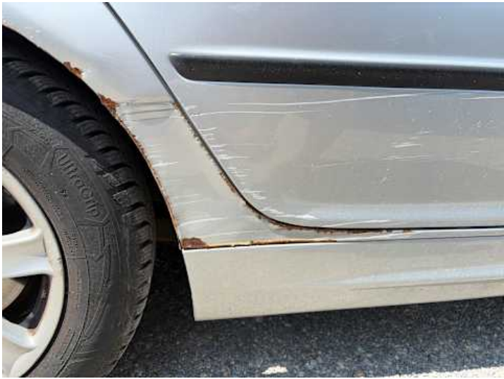
Seitenteil hinten rechts (Verformung, Lackschaden, Rost)
