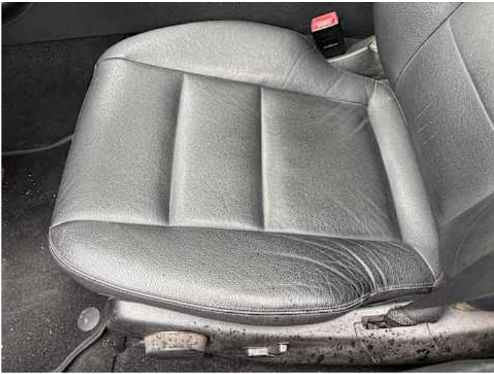
Innenraum (Verschleiß, Verschmutzung)
