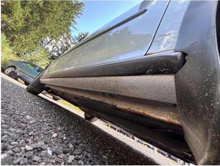
Schweller rechts (Unsachgemäß instand gesetzt, Rost)
