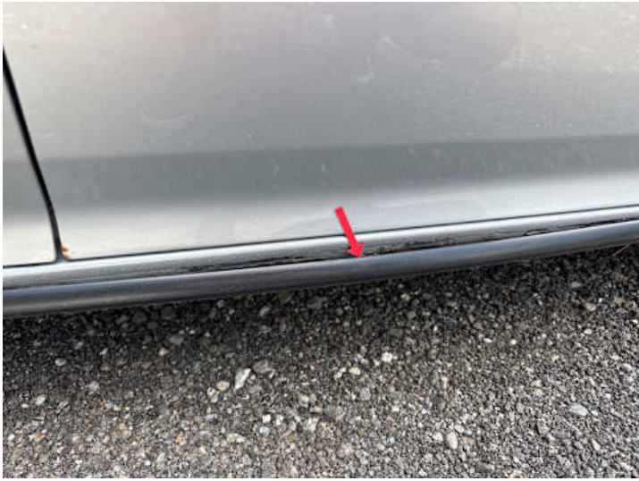
Schweller rechts (Unsachgemäß instand gesetzt, Rost)
