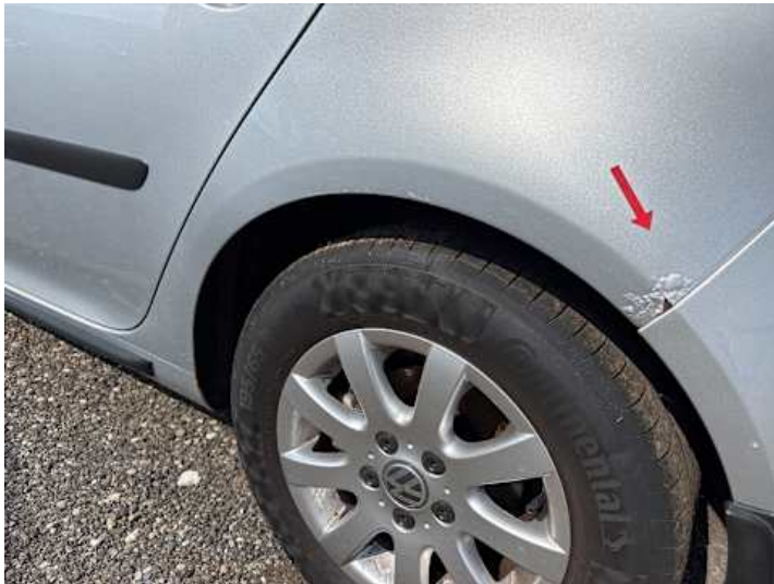
Seitenteil hinten links (Rost)
