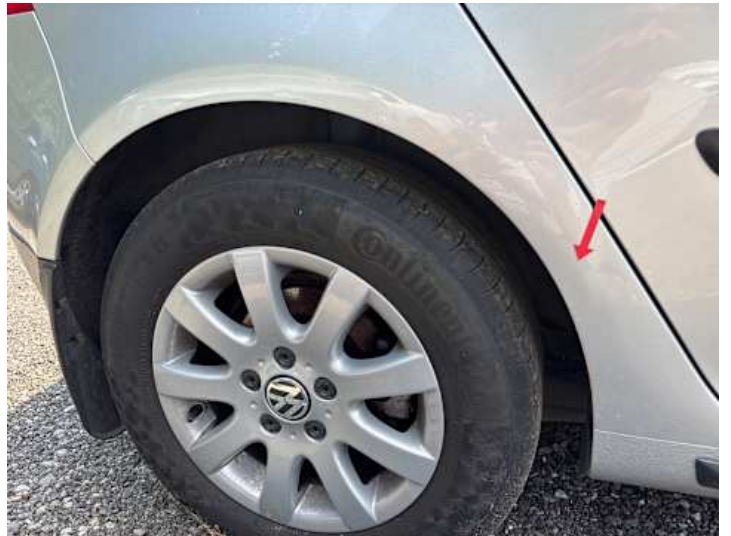
Seitenteil hinten rechts (Rost)
