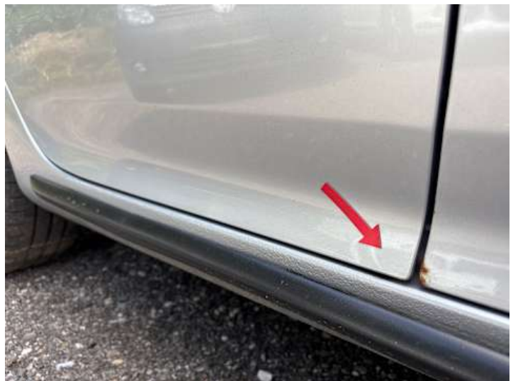
Türe hinten rechts (Rost)
