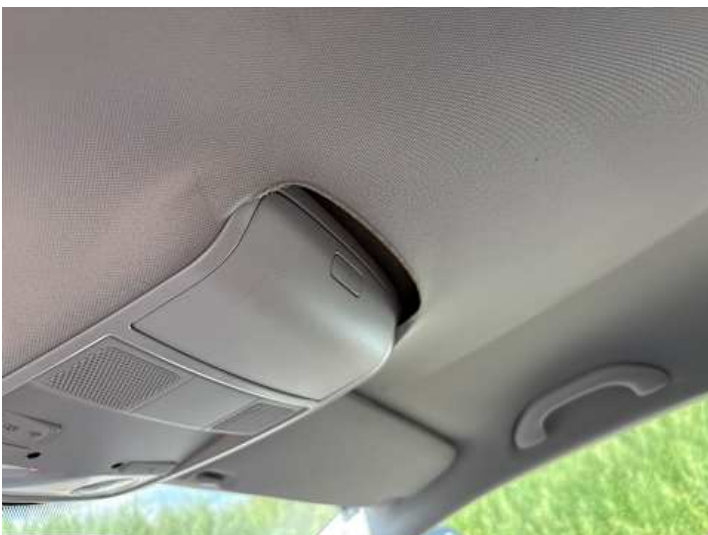
Innenraum (Ohne Funktion, Verschleiß, Riss/Bruch)
