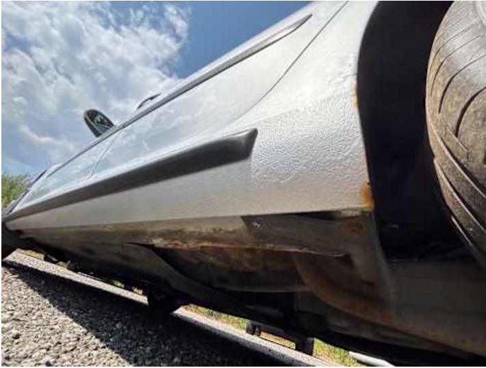
Schweller links (Rost)
