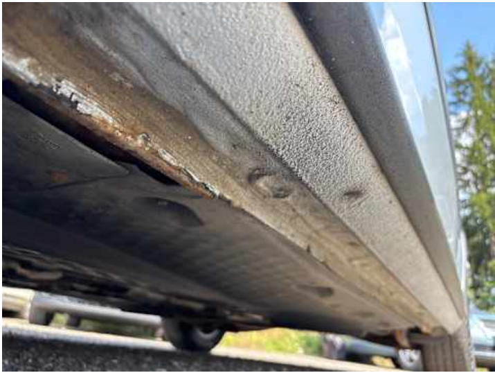
Schweller links (Rost)
