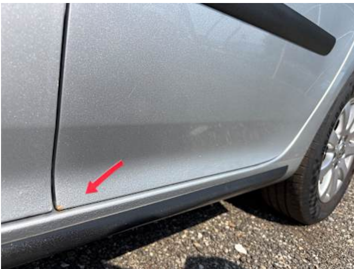
Türe hinten links (Rost)
