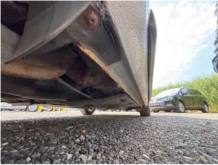
Schweller rechts (Unsachgemäß instand gesetzt, Rost)
