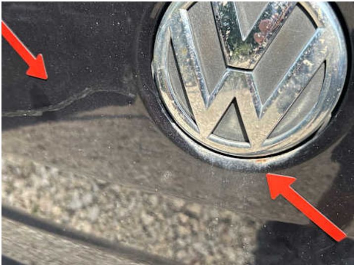
Heckklappe (Kratzer, Rost, Unsachgemäß instand gesetzt)
