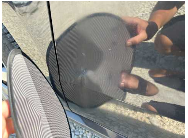
Fahrtür (Verformung, Kratzer, Unsachgemäß instand gesetzt)
