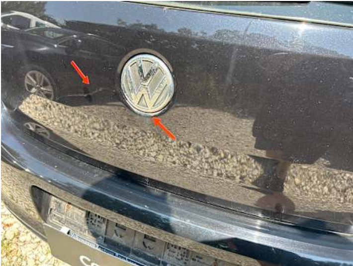
Heckklappe (Kratzer, Rost, Unsachgemäß instand gesetzt)
