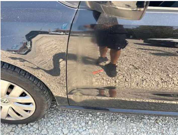
Fahrtür (Verformung, Kratzer, Unsachgemäß instand gesetzt)
