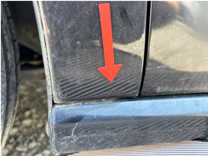
Kotflügel vorne links (Rost)
