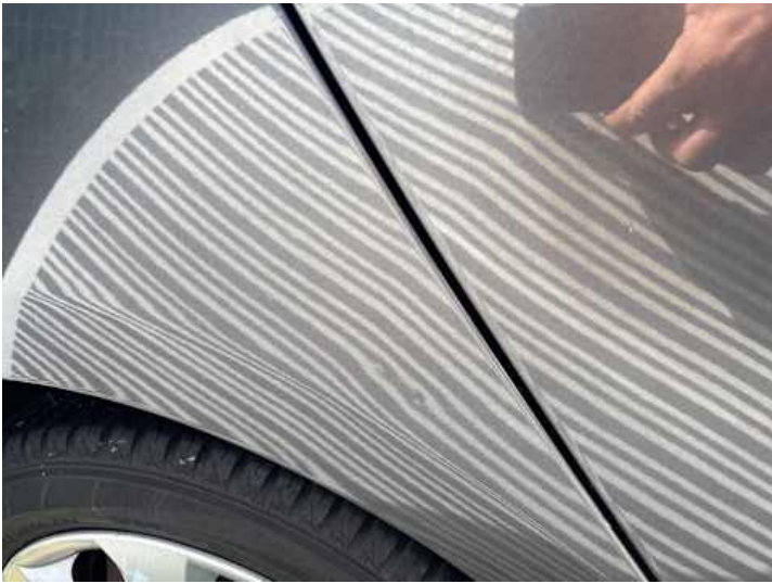
Seitenteil hinten rechts (Delle)
