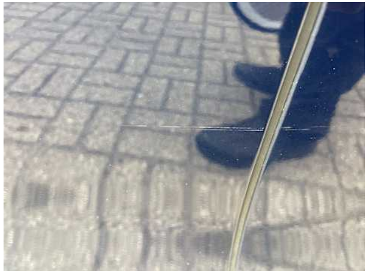
Fahrertür (Lackschaden, Kratzer)
