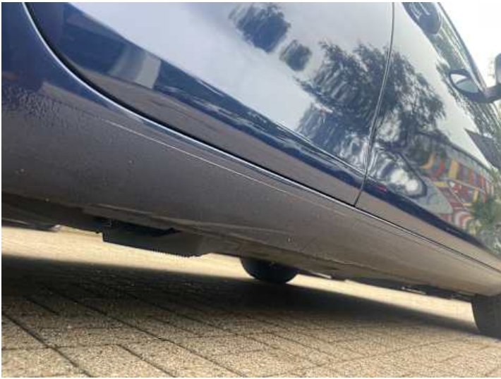
Schweller rechts (Verformung)
