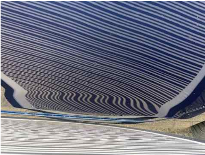
Türe hinten links (Delle)
