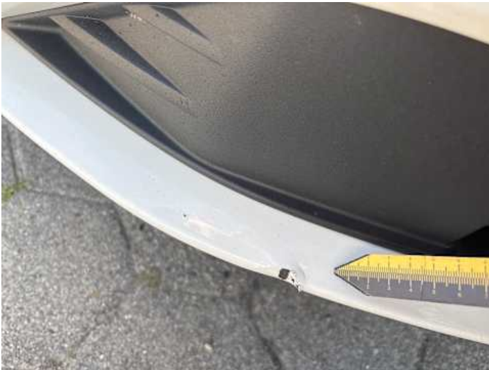
Stoßstange vorne (Verformung)
