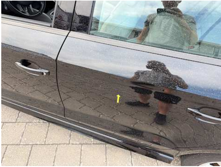
Türe hinten links (Kratzer)
