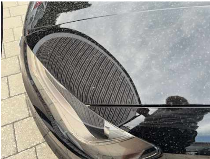
Motorhaube (Lackschaden, Kratzer, Delle)
