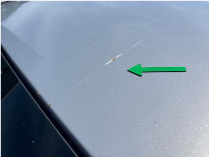
Dach (Kratzer, Rost)
