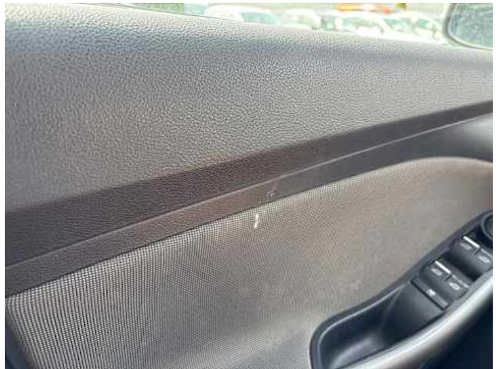
Innenraum (Brandloch, Verschmutzung)
