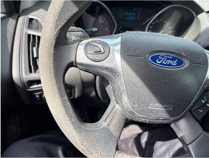
Innenraum (Riss/Bruch, Verschleiß)
