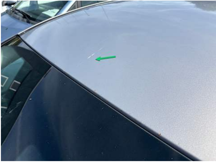
Dach (Kratzer, Rost)
