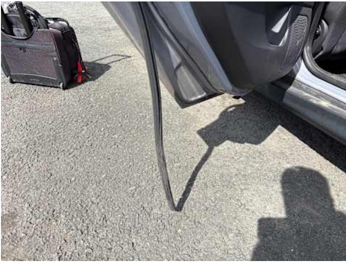
Türe hinten links (Anderer Schaden): Dichtung lose,
