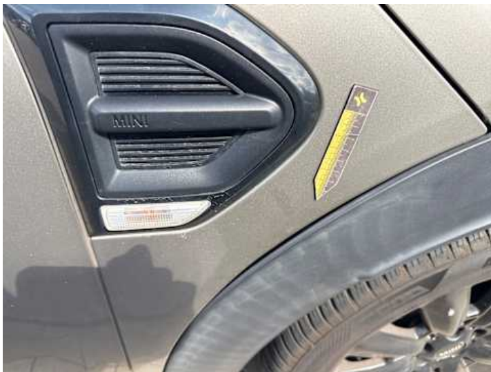
Kotflügel vorne rechts (Spaltmaße ungenau)
