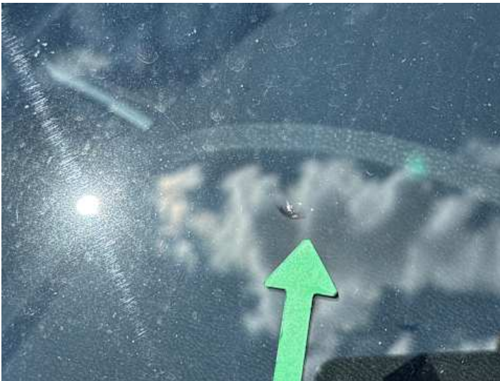
Windschutzscheibe (Steinschlag, Riss/Bruch)
