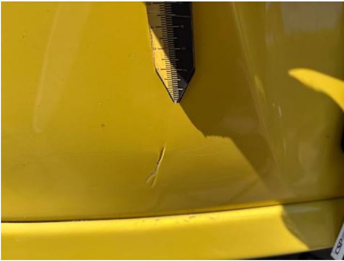
Stoßstange hinten (Kratzer, Verformung)
