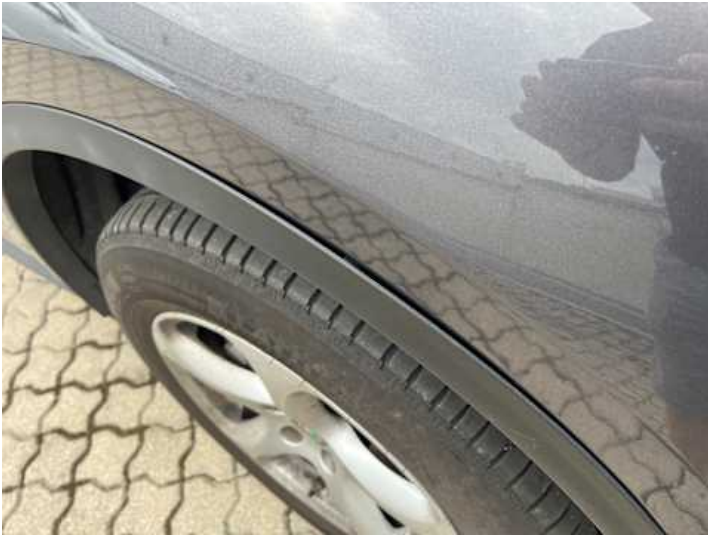
Kotflügel vorne rechts (Spaltmaße ungenau)
