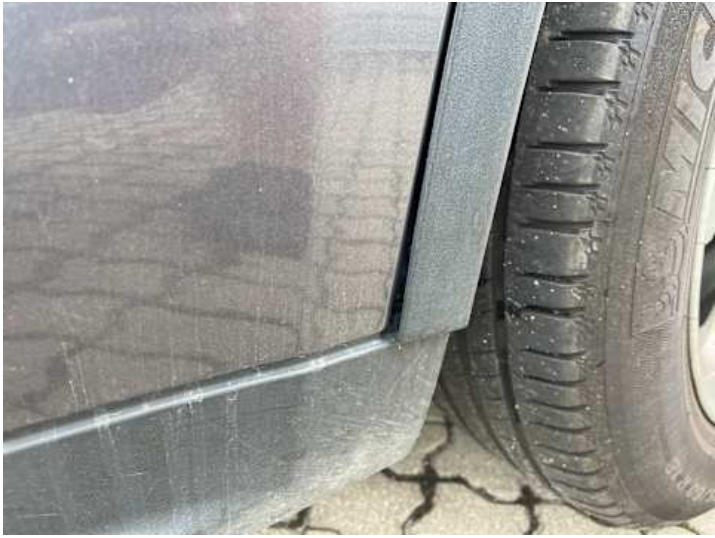
Kotflügel vorne rechts (Spaltmaße ungenau)
