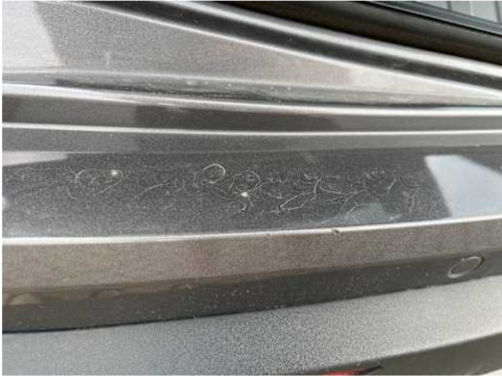
Stoßstange hinten (Kratzer)
