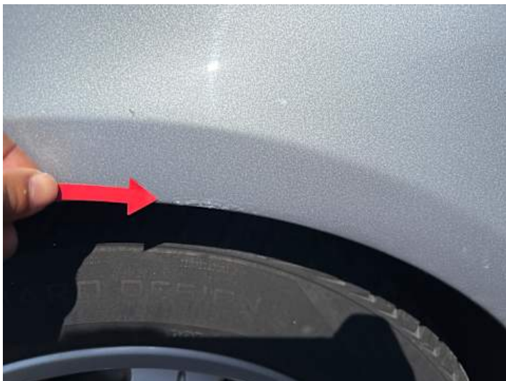
Seitenteil hinten rechts (Rost)
