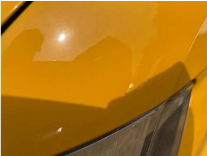
Kotflügel vorne links (Lackschaden, Steinschlag)
