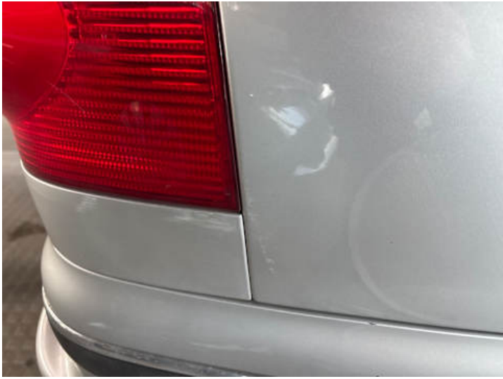
Seitenteil hinten rechts (Rost, Lackschaden, Kratzer)
