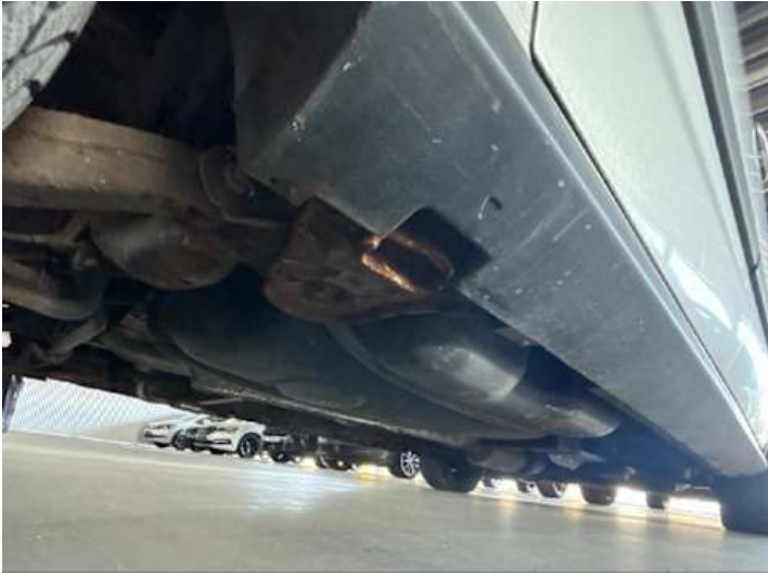
Schweller rechts (Lackschaden, Rost)
