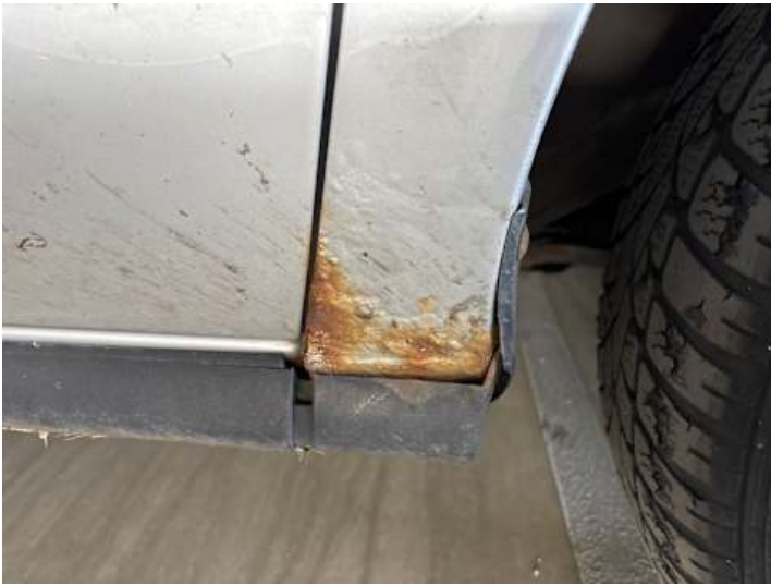
Kotflügel vorne rechts (Lackschaden, Rost)
