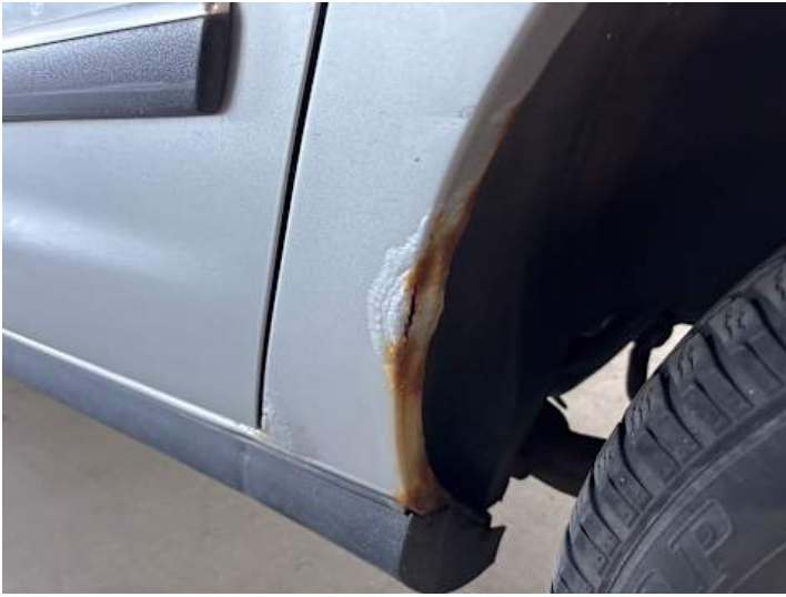
Seitenteil hinten links (Lackschaden, Rost)
