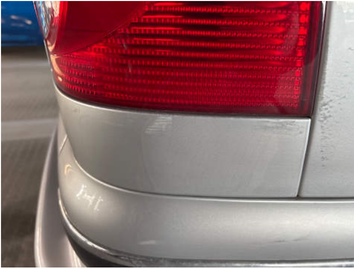
Stoßstange hinten (Kratzer, Lackschaden, Verformung)
