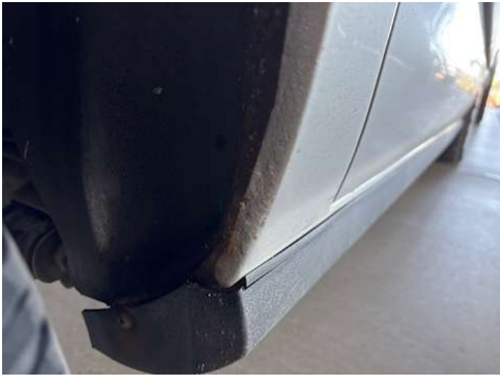
Seitenteil hinten rechts (Rost, Lackschaden, Kratzer)
