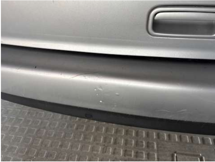
Stoßstange hinten (Kratzer, Lackschaden, Verformung)
