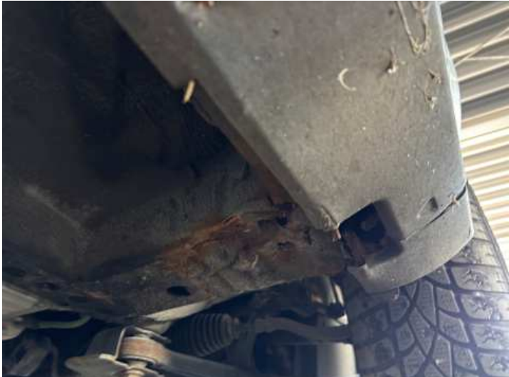
Schweller rechts (Lackschaden, Rost)
