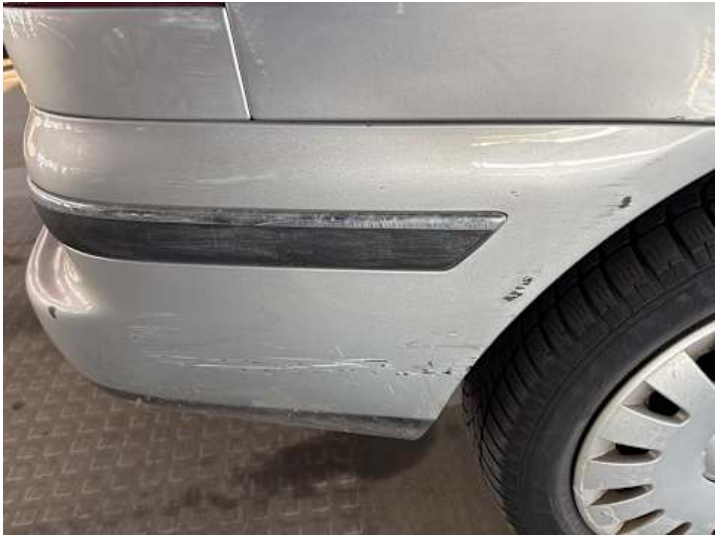
Stoßstange hinten (Kratzer, Lackschaden, Verformung)
