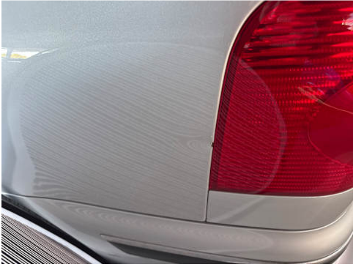
Seitenteil hinten links (Delle, Lackschaden, Rost)
