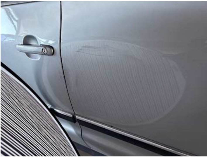
Türe hinten links (Verformung, Kratzer, Lackschaden)
