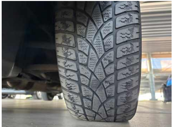
Rad (Riss/Bruch, Ungleichmäßig abgefahren, vehicle.damage-label.porous)
