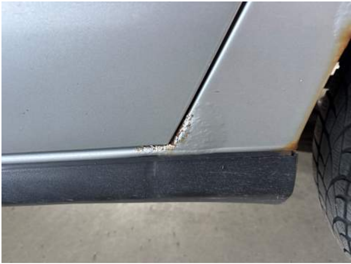
Schweller links (Rost, Lackschaden)
