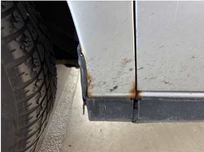
Kotflügel vorne links (Lackschaden, Rost, Delle)
