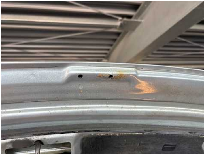
Motorhaube (Lackschaden, Rost)
