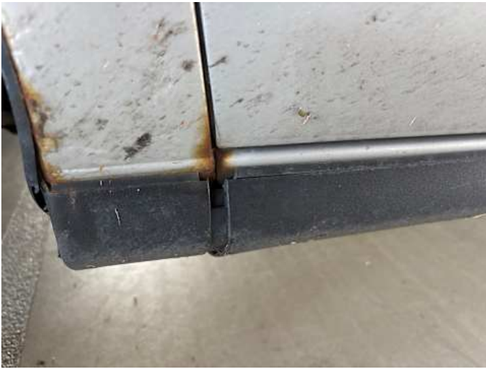
Schweller links (Rost, Lackschaden)
