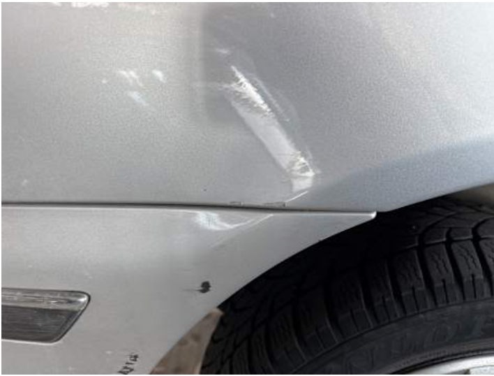
Seitenteil hinten rechts (Rost, Lackschaden, Kratzer)
