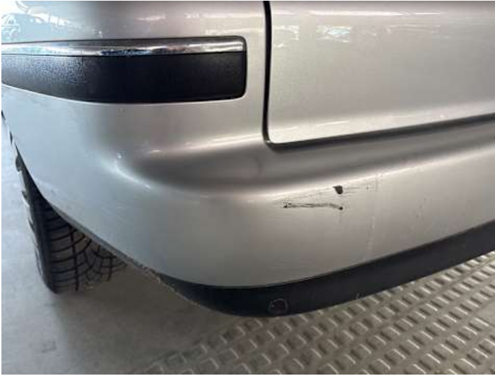
Stoßstange hinten (Kratzer, Lackschaden, Verformung)
