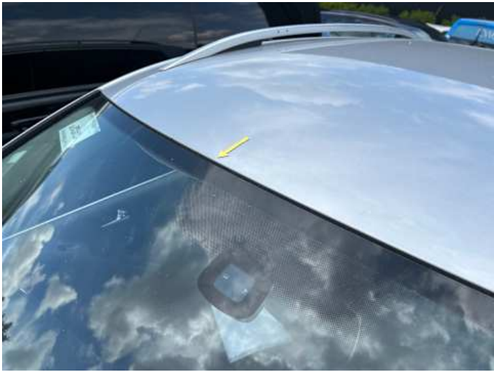
Dach (Steinschlag, Lackschaden)
