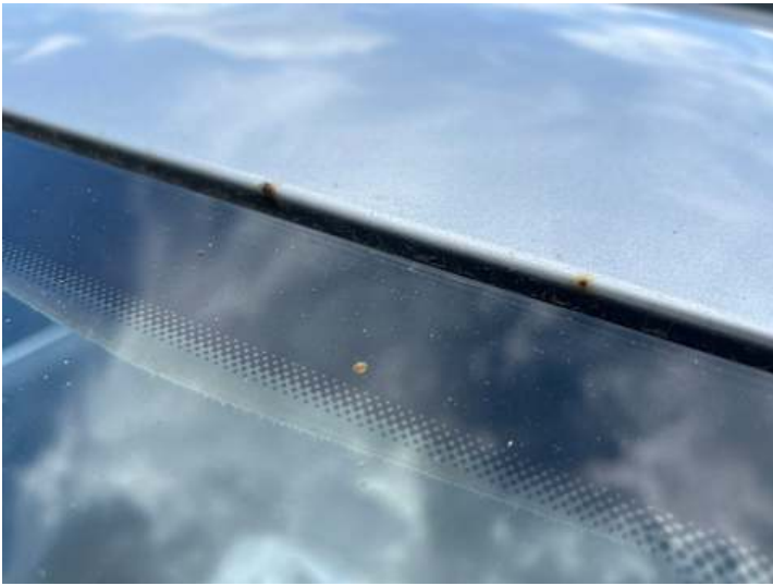
Dach (Steinschlag, Lackschaden)
