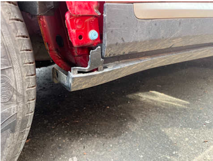
Schweller links (Riss/Bruch)
