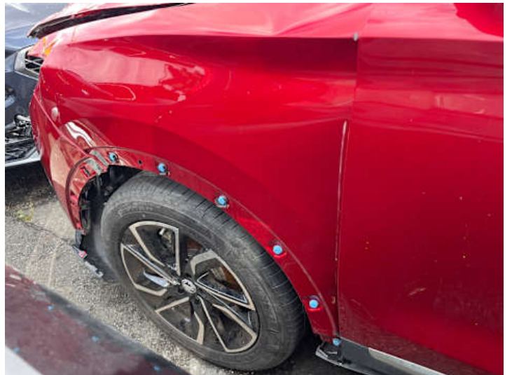
Kotflügel vorne links (Riss/Bruch, Lackschaden, Verformung)
