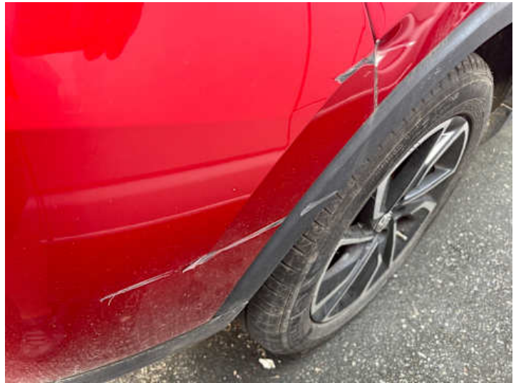
Stoßstange hinten (Lackschaden, Kratzer)
