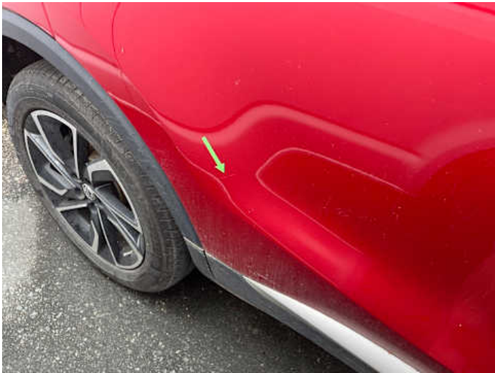
Türe hinten rechts (Lackschaden, Kratzer)
