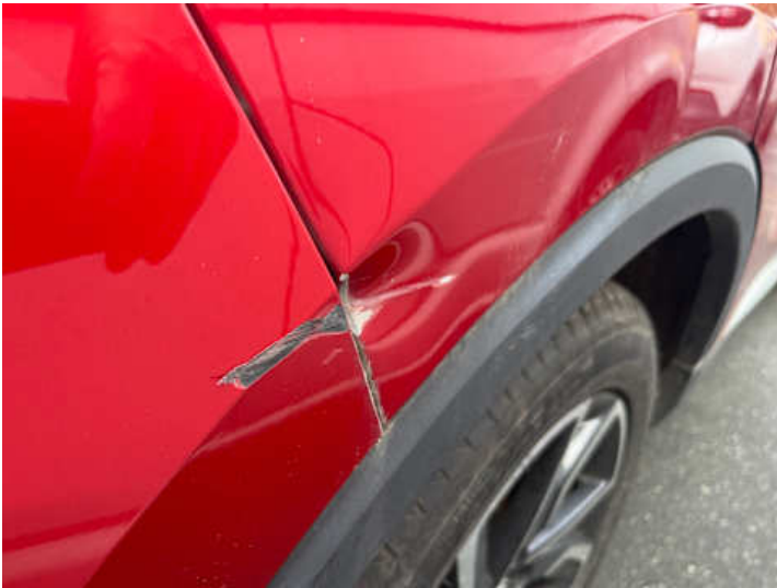
Seitenteil hinten rechts (Lackschaden, Kratzer, Delle)
