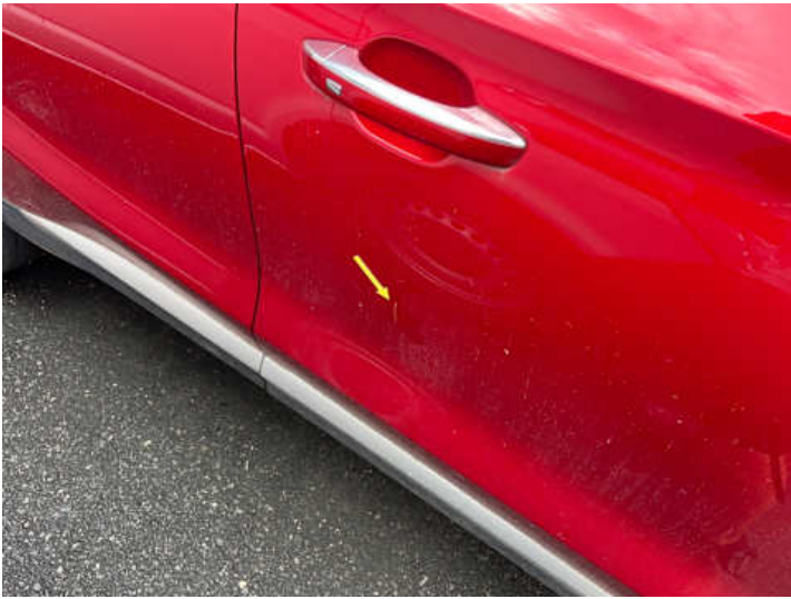
Beifahrertür (Lackschaden, Kratzer)
