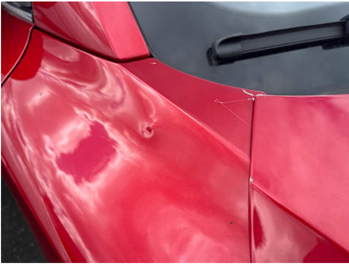
Kotflügel vorne rechts (Lackschaden, Kratzer, Verformung)
