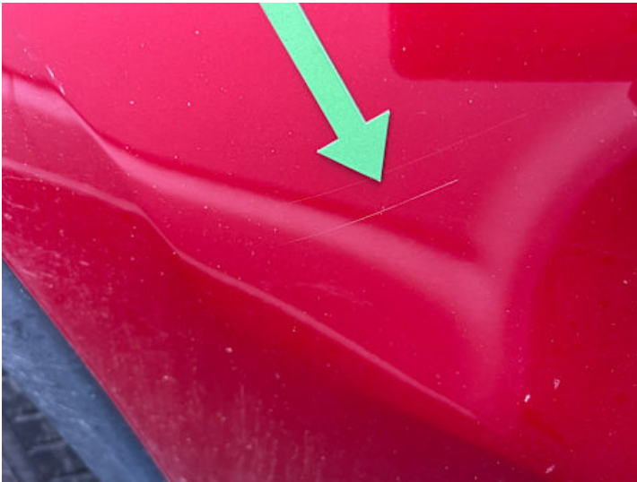
Türe hinten rechts (Lackschaden, Kratzer)
