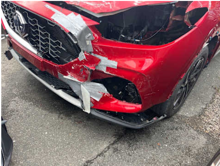
Stoßstange vorne (Riss/Bruch)
