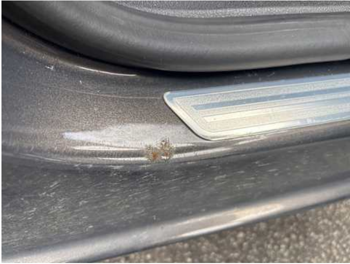
Schweller links (Rost)
