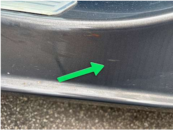
Schweller links (Kratzer)
