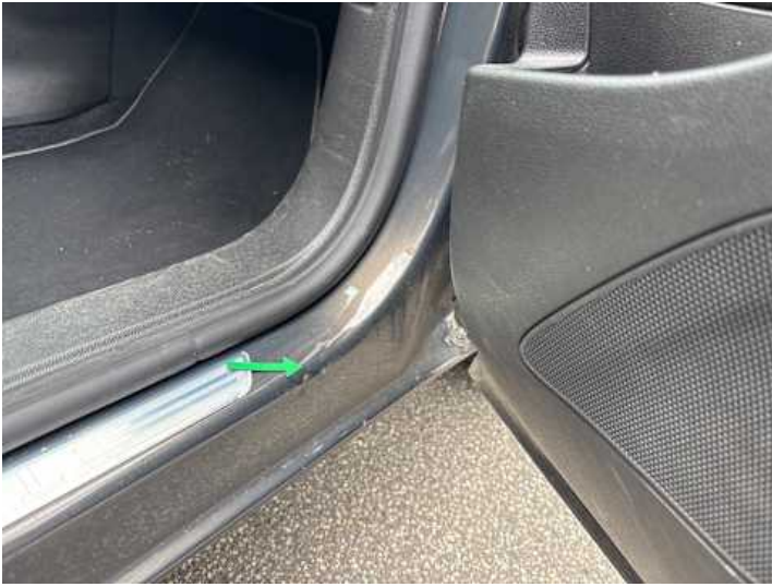
Schweller rechts (Rost)
