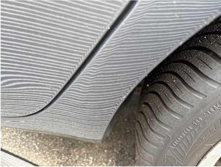
Seitenteil hinten links (Unsachgemäß instand gesetzt)
