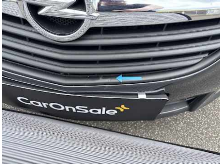
Stoßstange vorne (Verformung, Riss/Bruch)
