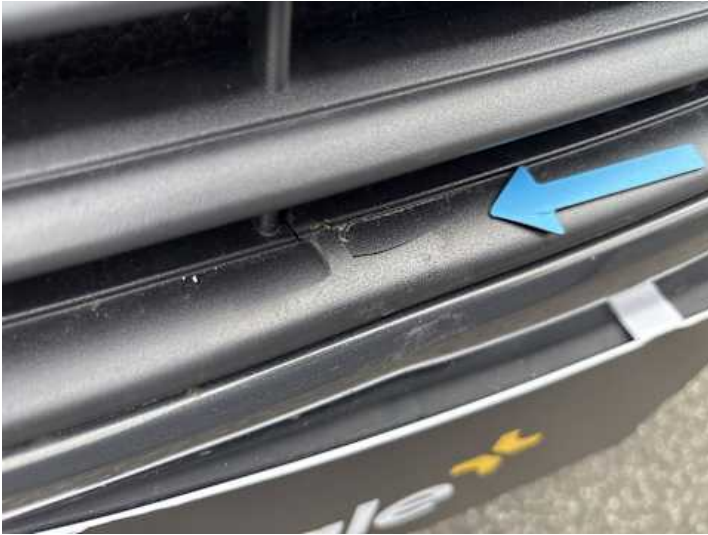
Stoßstange vorne (Verformung, Riss/Bruch)
