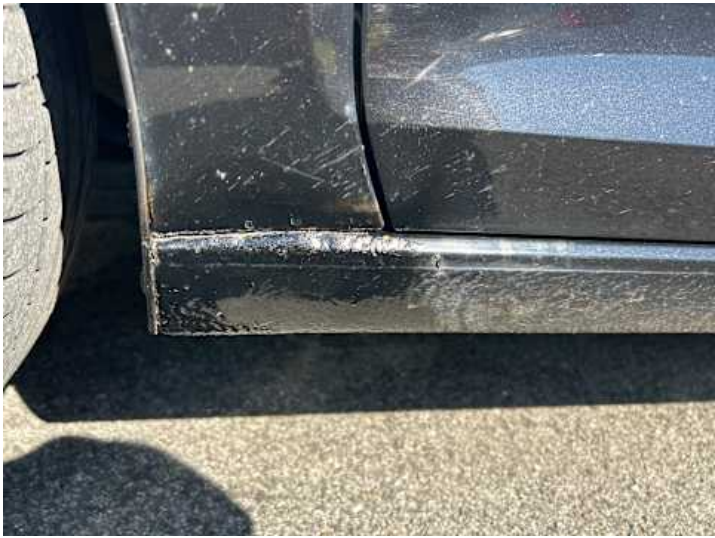
Schweller links (Rost)
