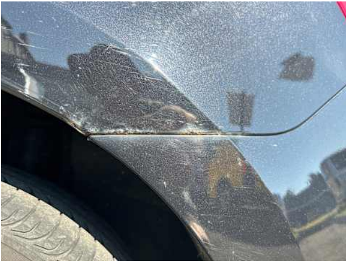
Seitenteil hinten links (Rost)
