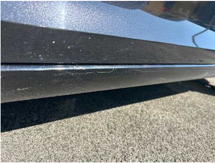
Schweller links (Unsachgemäß instand gesetzt)
