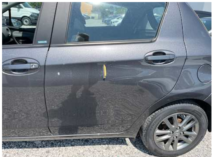
Türe hinten links (Kratzer, Lackschaden)
