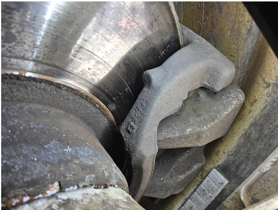
Bild 36 : Bremse vorn verschlissen
