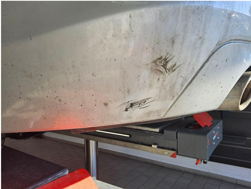
Bild 37 : Fahrzeug umlaufenden mit Karosserie Schäden, Reparaturkosten geschätzt
