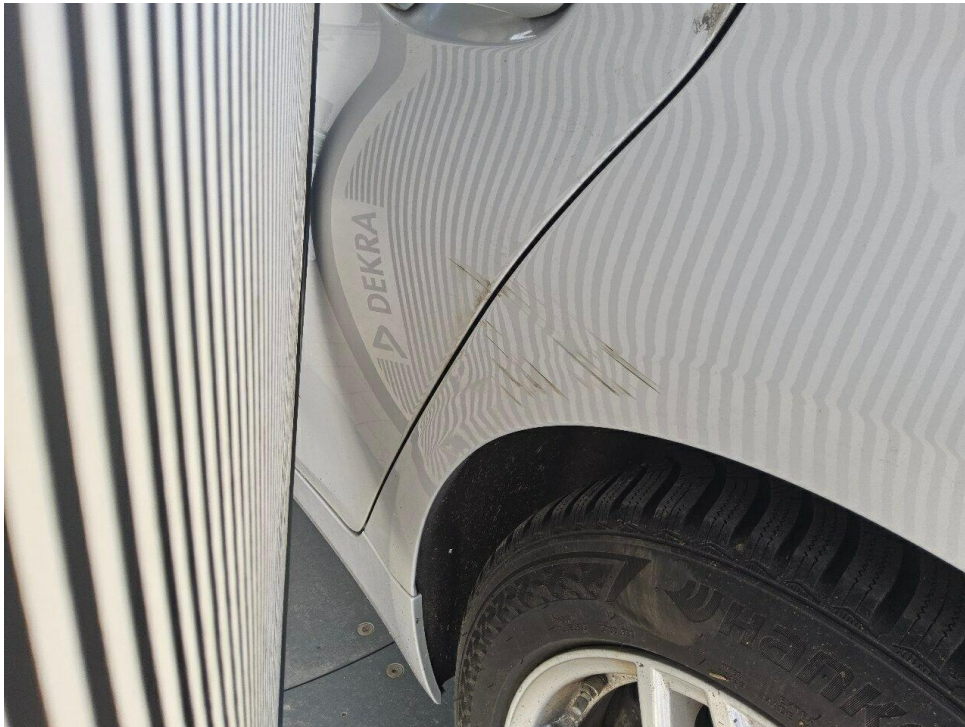
Bild 29 : Fahrzeug umlaufenden mit Karosserie Schäden, Reparaturkosten geschätzt
