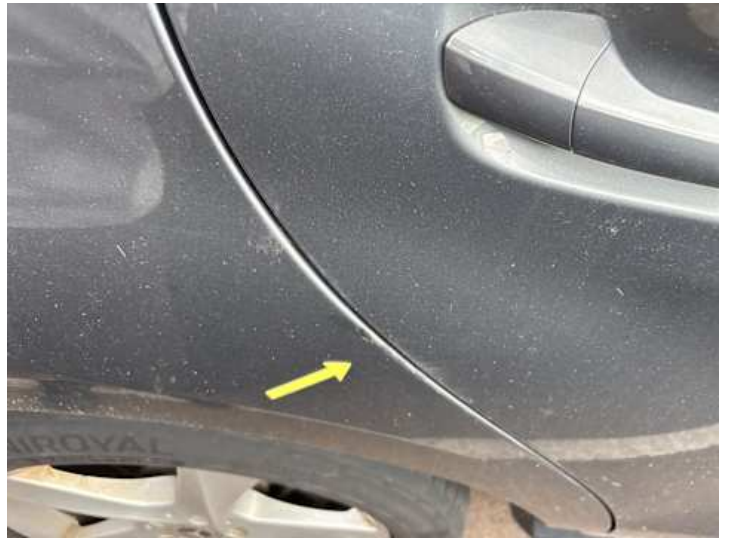
Seitenteil hinten rechts (Kratzer, Unsachgemäß instand gesetzt)
