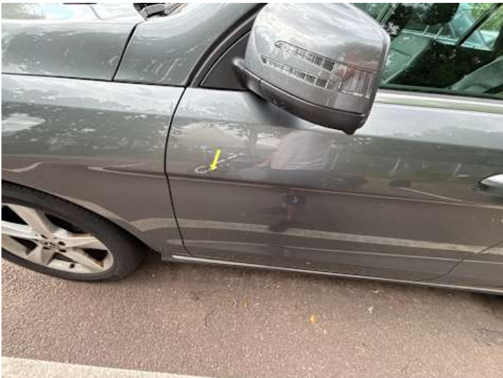
Fahrtür (Delle, Kratzer)
