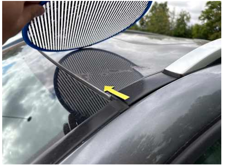
Dach (Delle, Lackschaden, Unsachgemäß instand gesetzt)
