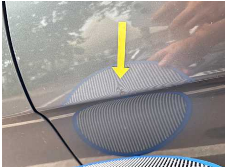
Fahrtür (Delle, Kratzer)
