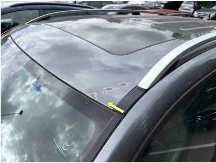
Dach (Delle, Lackschaden, Unsachgemäß instand gesetzt)
