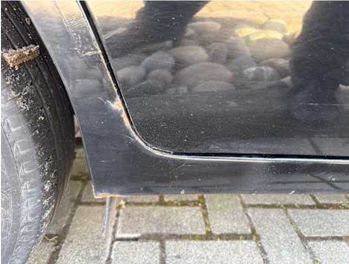
Schweller rechts (Rost, Lackschaden)
