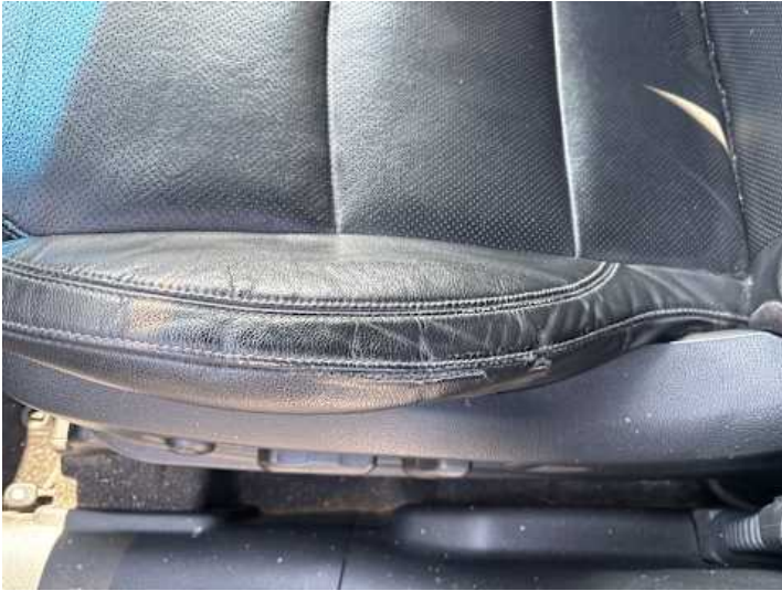
Innenraum (Riss/Bruch, Verschleiß, Kratzer)
