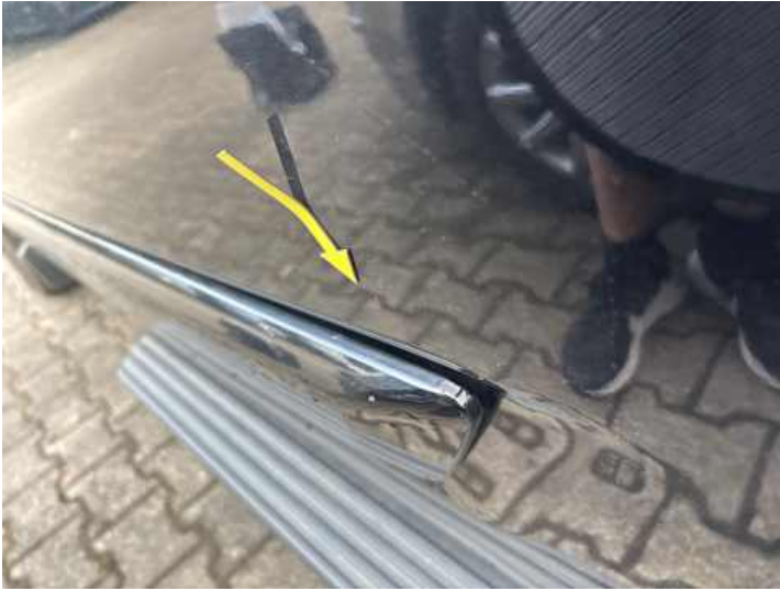
Türe hinten links (Spaltmaße ungenau)
