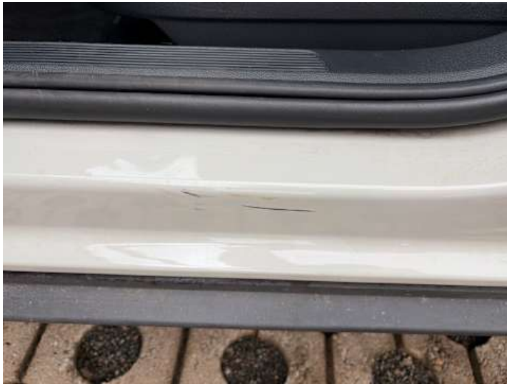
Schweller links (Lackschaden)
